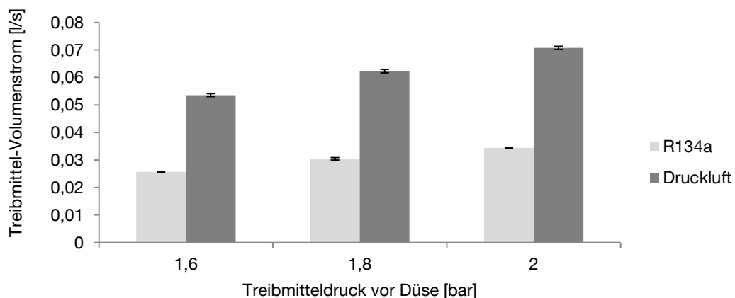
Abb. 4.7 Treibmittel-Volumenströme in Abhängigkeit des Eingangsdrucks
