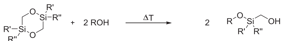
Schema 4.10: Ringöffnung cyclischer Alkoxy silane durch Alkohole. R' und R'' sind Alkyl oder Alkoxyreste.
