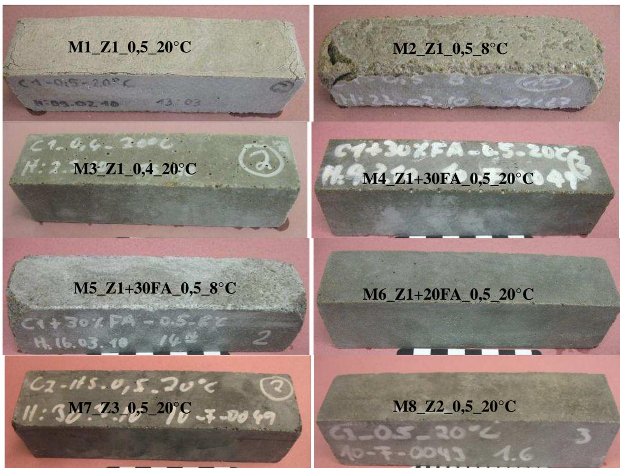
Abbildung A-V 1: Fotos der Prismen (4×4×16 cm<sup>3</sup>) der Mischungen M1-M8 nach einem Jahr Lagerungsdauer in einer Sulfatkonzentration von 30 g/l
