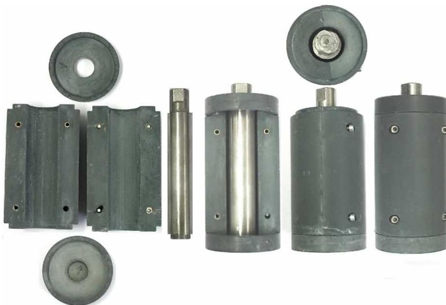
Abbildung 3-3: Formen für die Herstellung der Feinmörtel-Hohlzylinder
