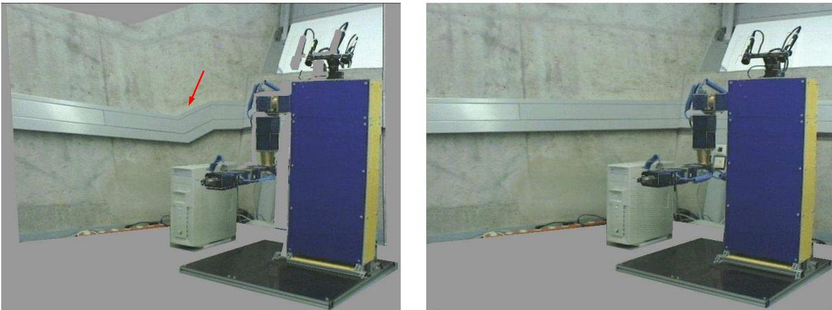
Abbildung 4.3: links: Verzerrungen durch in den Texturen enthaltene Perspektive, rechts: mit perspektivischer Korrektur
