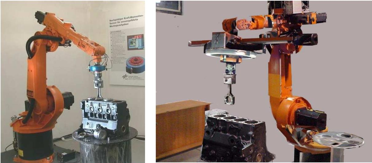
Abbildung 7.6: links: Einfügen eines Kolbens in einen Motorblock, rechts: Prädizierte Ansicht
