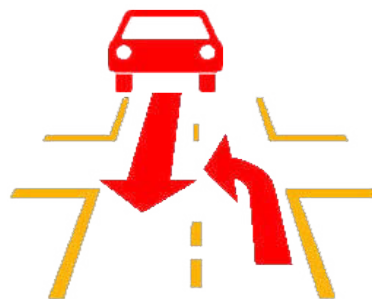
Bild 8: Warnsymbol im Head-Up-Display bei Systemeingriff
