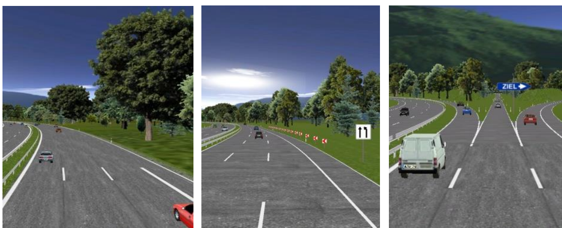
Abbildung 6-22: Darstellung der Übernahmeszenarien. Links: Wegfall der vom System benötigten Fahrstreifenmarkierungen (FBM); Mitte: Fahrstreifenwechsel aufgrund Fahrbahnverengung (FBV); Rechts: Fahrstreifenwechsel mit zusätzlicher Orientierung hinsichtlich des Zielfahrstreifens (über Beschilderung vorgegeben, FBT).
