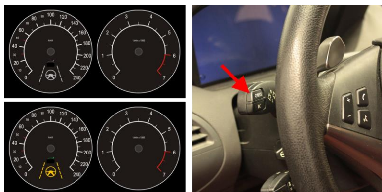
Abbildung 6-2: Links: Anzeige für eine verfügbare (grau) bzw. aktive (farbig) Automationsunterstützung. Rechts: Die Aktivierung der Automation erfolgte durch die Probanden selbst über Betätigung der „Check“-Taste am Blinkerhebel.
