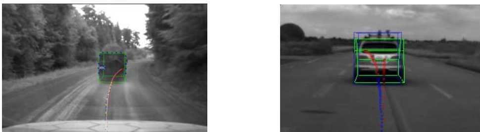
Abbildung 13. Tracking von 3D-Merkmalenmodellen. Links zeigt die rote Linie den prädizierten weiteren Trajektorienverlauf aufgrund des Einspurmodells. Rechts ist die Referenzierung der Posenschätzung (grünes Modell) zu DPGS Ground Truth (blaues Modell) dargestellt.
