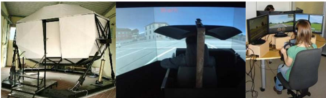
Bild 3-2: Fahrsimulatoren in sim TD (von links nach rechts: Fahrsimulator mit Bewegungssystem, Fahrstand und Pulksimulation) [Quelle: WIVW GmbH]
