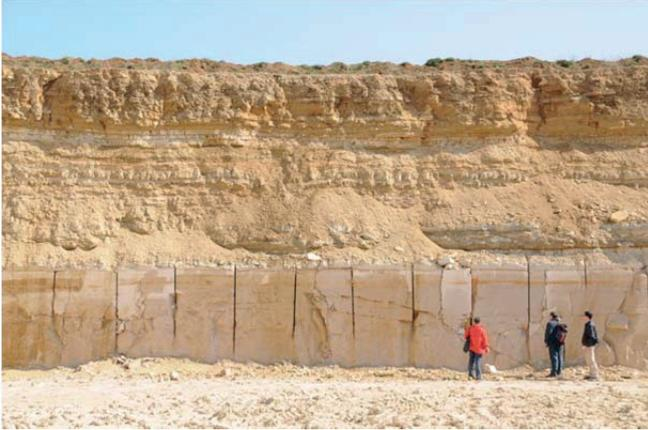
Abb. 13: Im Steinbruch „de la Longue Queue“ zwischen Juvigny und Savonnières wird Oolith vom Savonnières-Typ in einer über 3 m dicken Werksteinbank abgebaut. Man erkennt die mehrere Meter mächtige Überlagerung mit Kreide-Sedimenten.
