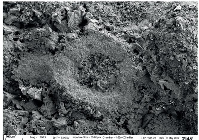
Abb. 12: REM-Aufnahme von Ooiden im „Morley-Oolith“ mit calcitischen Rändern, feinkörnigen Dolomit-Kernen und tw. stark korrodierten Dolomitrhomboedern in den Zwickeln.
