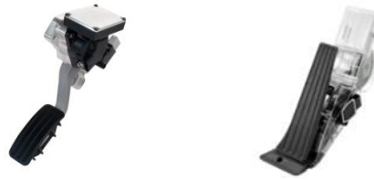
Abbildung 2.8: Hängendes (links) und stehendes (rechts) Fahrpedal, in der Ausführungsform eines aktiven Fahrpedals (LANGE 2008, ZELL et al. 2010)
