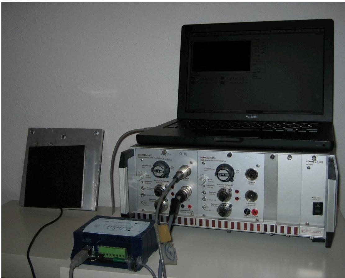
Abb. 14: Kompletter Versuchsaufbau der Kraftmessplatte.
