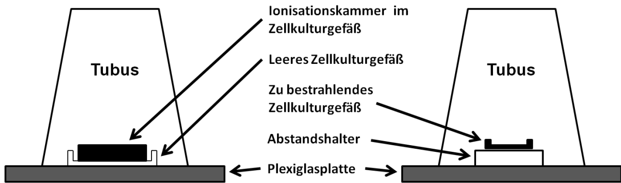
Abb. 2-1: Versuchsaufbau zur Bestrahlung am RT-100. Das linke Bild zeigt den Aufbau bei der Dosimetrie, die Ionisationskammer liegt in einem leeren Zellkulturgefäß und wird darauf fixiert. Das rechte Bild zeigt den Aufbau bei Bestrahlung der Zellen. Der Boden des Zellkulturgefäßes und das Fenster der Ionisationskammer befinden sich auf einer Höhe.
