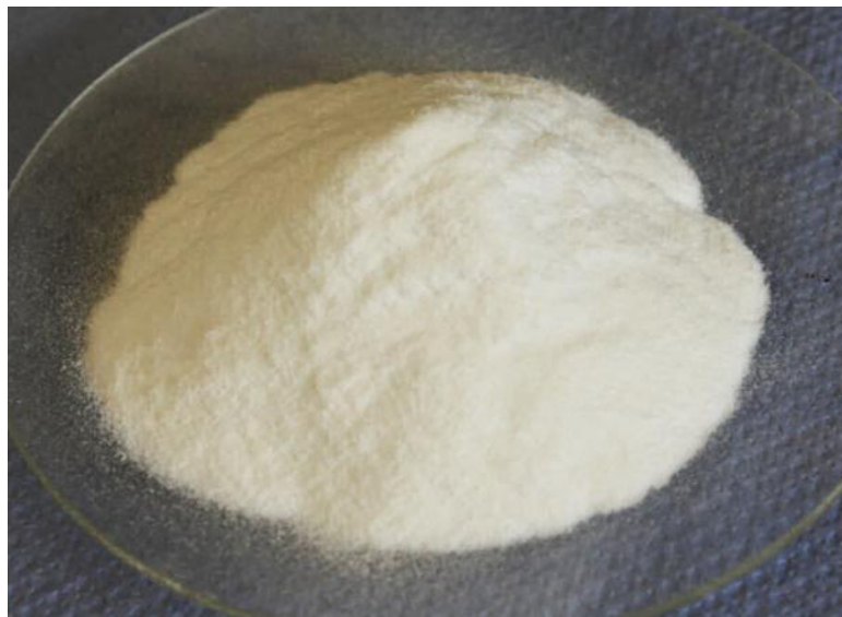
Abbildung 17 – Typisches weiß-gelbes Celluloseether-Pulver; die Korngröße in dieser Probe lag bei < 180 µm.
