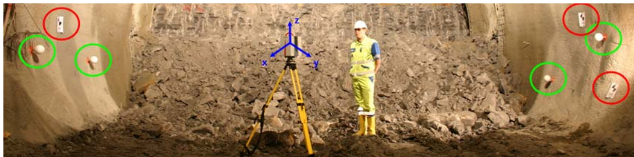
Abb. 4.17: Laserscanningmessung mit lokalem Scannerkoordinatensystem (blau), Passkugeln (grün) und Passmarken (rot)
