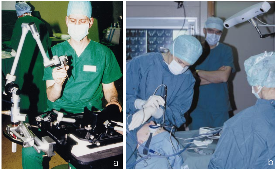
Abbildung 2.4: Beispiele für elektromechanische und elektrooptische Trackingverfahren. (a) Der elektromechanische Messarm des ISG Viewing Wand Navigationssystems (aus Gunkel et al. 2000). (b) Das Neuroguide Navigationssystem von Philips (Philips Healthcare GmbH, Hamburg, Deutschland) im klinischen Einsatz. Die Chirurgin hält eine mit aktiven LEDs bestückte navigierte Probe in der Hand, deren Lage von der Stereokamera, rechts oben im Bild, erfasst wird. Klar zu erkennen ist das Kabel zur Stromversorgung und Kopplung des Instruments mit dem Messsystem. Der Patient selbst wird beim Neuroguide System mit einem aktiven Tracker referenziert, der an einer Brille befestigt ist, die vom Patienten während der OP getragen wird. (aus Vorbeck et al. 2000).
