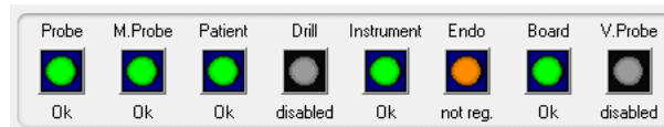
Abbildung 5.34: Experimentelle Visualisierung nach einem Trackertausch. Der Fräsentracker wurde verdeckt und die technische Messplatte in den Arbeitsraum der Kamera gehalten. Daraufhin wurde der Fräsentracker deaktiviert (jetzt grau dargestellt) und der Tracker der Messplatte aktiviert (jetzt grün dargestellt).
