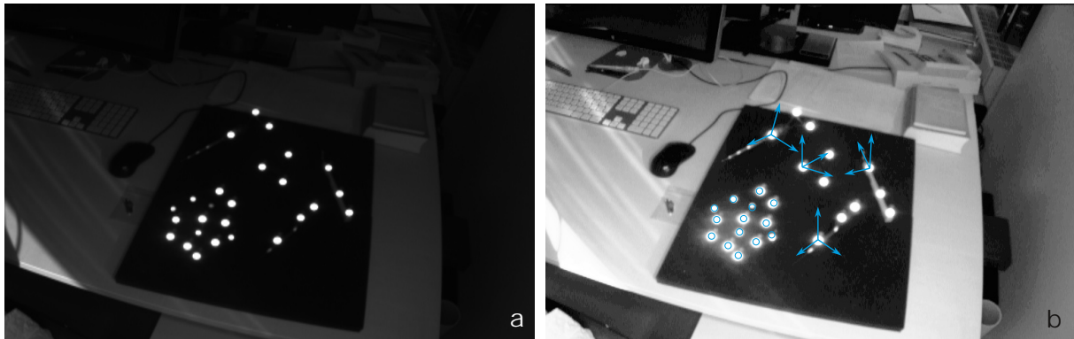
Abbildung 5.31: Identifikation von Trackern anhand von stray marker Positionen. (a) Zeigt das Originalbild, welches von einem der beiden CCD Chips der Navigationskamera aufgenommen wurde. In (b) ist dasselbe Bild nach automatischem Weißabgleich dargestellt. Die Kamera war bei der Aufnahme auf einen Tisch mit mehreren Instrumenten und montierten Instrumententrackern gerichtet. Zusätzlich liegen mehrere einzelne Reflektoren auf dem Tisch verstreut. Die Reflektionen des von der Navigationskamera ausgesandten Infrarotlichts in den Reflektoren sind klar als helle Punkte erkennbar. In cyan sind die Informationen eingezeichnet, die von der Navigationskamera an das Navigationssystem zurückgeliefert werden. Für alle aktivierten Tracker wird deren derzeitige Lage berechnet und als homogene Transformationsmatrix zurückgeliefert. Die Positionen aller Reflektionen, die keinem aktivierten Tracker zugeordnet werden konnten, sind ebenfalls verfügbar und können vom Navigationssystem weiter verarbeitet werden.
