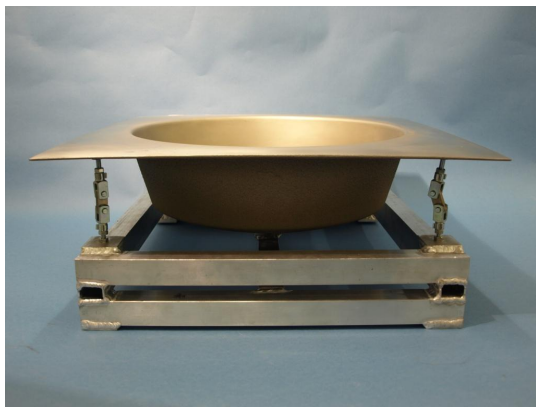
(a) Laminiervorrichtung mit Hinterbau
