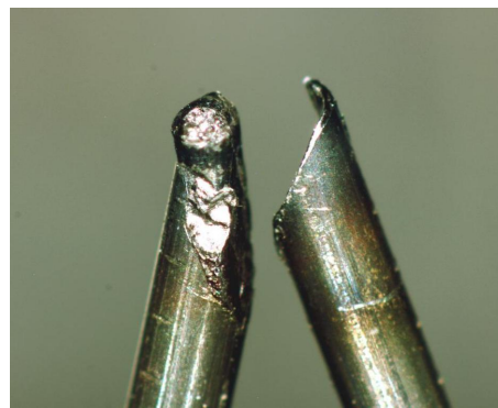
(b) Abbrand des Drahtes ( d = 1,6 \text{ mm} ) nach dem Lichtbogenspritzen
