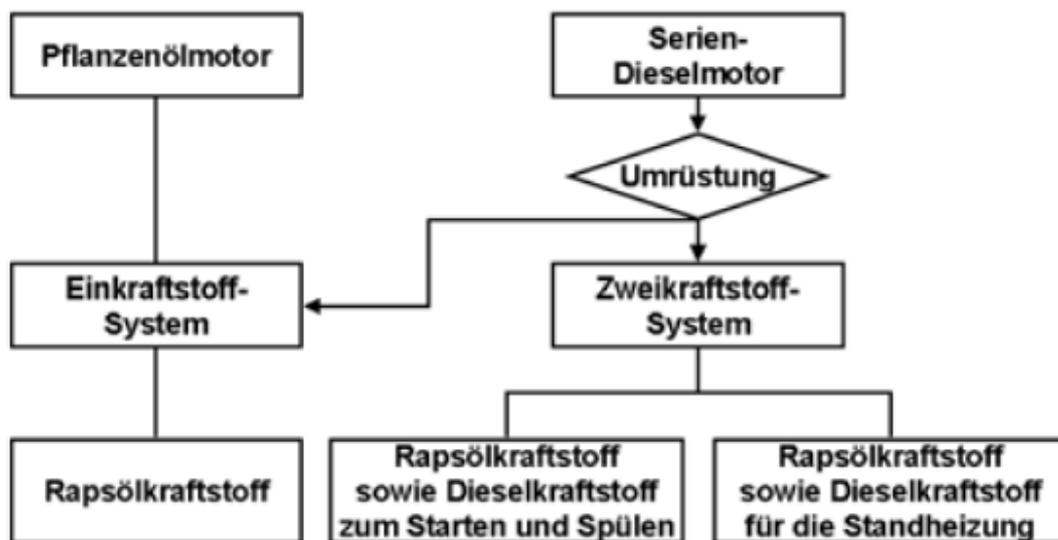
Abbildung 9: Einordnung von pflanzenötauglichen Motoren nach dem Kraftstoffsystem [145]
