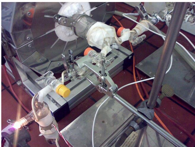
**Abbildung 2.1:** Strömungskopf der Synthese-Apparatur mit Beheizung für die Synthese der  $\epsilon$ -Eisencarbonitride.
