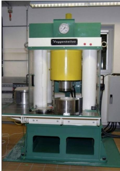
**Abbildung 2.4:** Hydraulische Presse der Firma *Voggenreiter* zur Erzeugung der primären Preßkraft (Bildquelle: MPI CPfS, Dresden).
