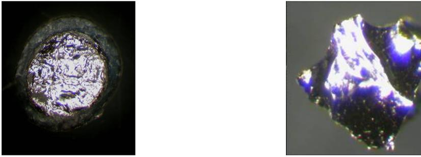
**Abbildung 4.20:**  $\epsilon\text{-Fe}_3\text{N}_{1,08}$  nach einer HP-HT Synthese. Links: Makrofoto eines Querschnitts durch das Tiegelmaterial ( $h\text{-BN}$ , dunkelgrau) und das vollkristallin umgewandelte  $\epsilon\text{-Fe}_3\text{N}_{1,08}$  (hell metallisch glänzend, Durchmesser der Probe 2,5 mm). Rechts: Makrofoto eines Bruchstücks  $\epsilon\text{-Fe}_3\text{N}_{1,08}$  (lange Bildkante 0,3 mm).
