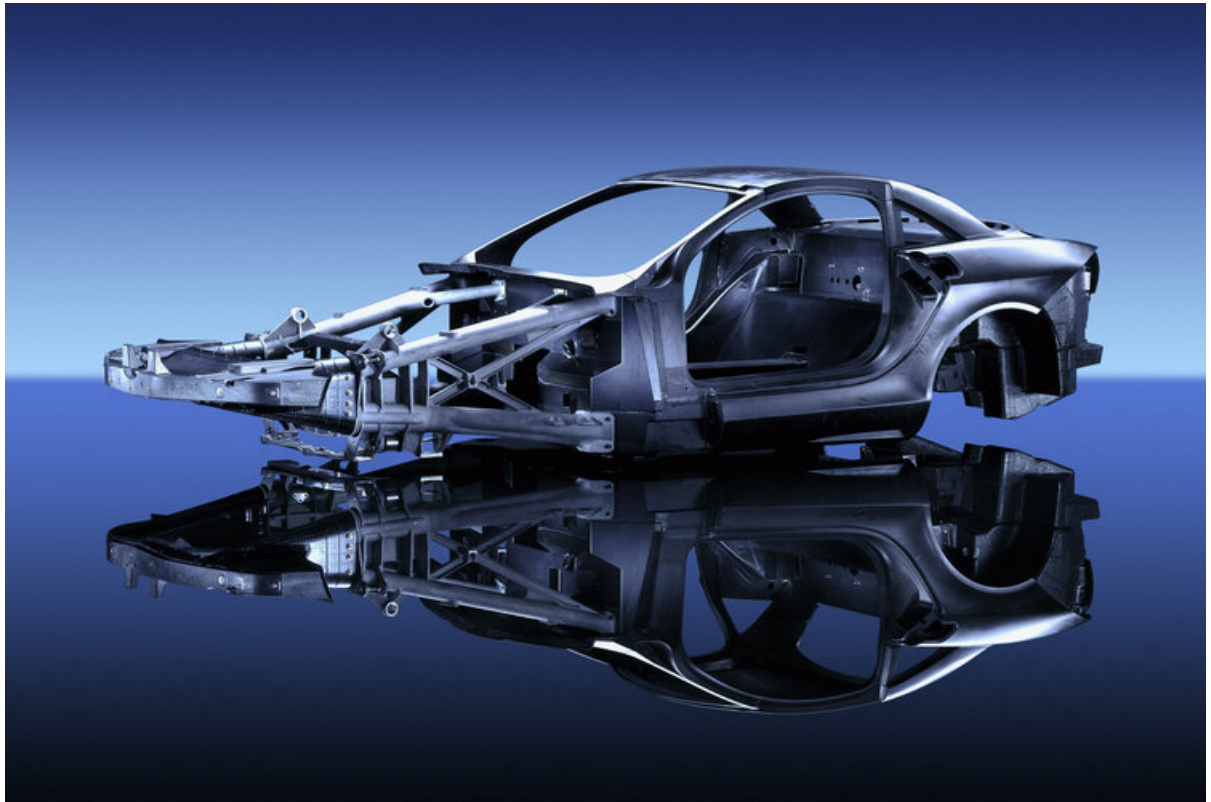
Abbildung 1.1: Rohbau des Mercedes-Benz SLR McLaren [15]
