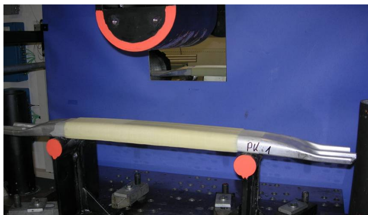
Abbildung 5.65: 3-Punkt-Biegeversuchsaufbau des Seitenaufprallträgers
