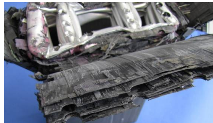
Abbildung 5.71: Interlaminare Delamination der CFK-Schichten
