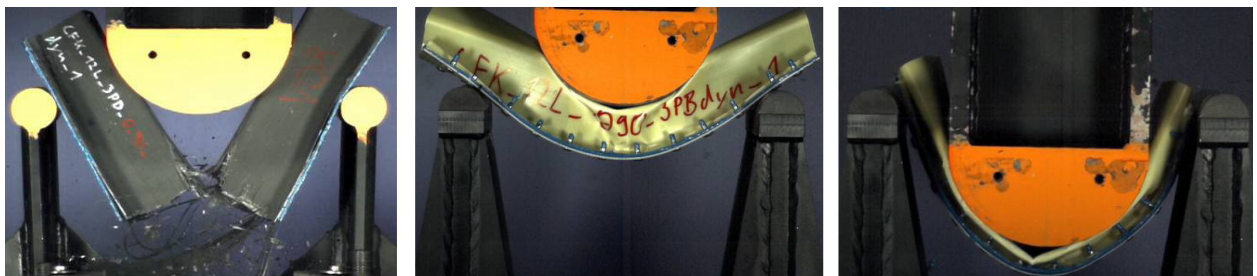
Abbildung 5.23: Maximale Intrusionstiefe reiner FVK-Bauteile bei 3-Punkt-Biegung: CFK 0^\circ/90^\circ (links), GFK 0^\circ/90^\circ (Mitte), GFK \pm 45^\circ (rechts)
