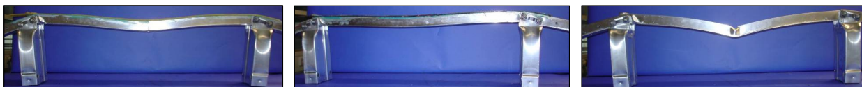
Abbildung 5.76: Biegequerträger nach Crashversuch: GFK-verstärktes Aluminiumprofil (links), CFK-verstärktes Aluminiumprofil (Mitte), reines Aluminiumprofil (rechts)
