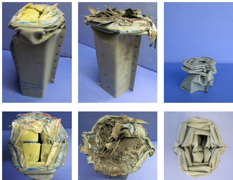
Abbildung 5.60: Stahlprofile nach Impakt unter Stauchbelastung: GFK-verstärktes Stahlprofil (links), CFK-verstärktes Stahlprofil (Mitte), reines Stahlprofil (rechts)
