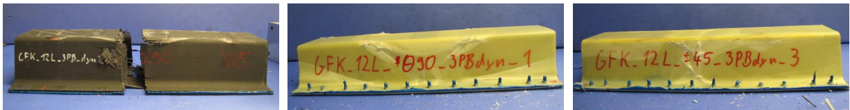
Abbildung 5.24: Reine FVK-Bauteile nach dem Versuch: CFK 0^\circ/90^\circ (links), GFK 0^\circ/90^\circ (Mitte), GFK \pm 45^\circ (rechts)
