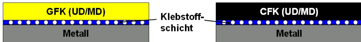
Abbildung 5.2: Aufbau der hybriden Strukturen (GFK/Metall und CFK/Metall)
