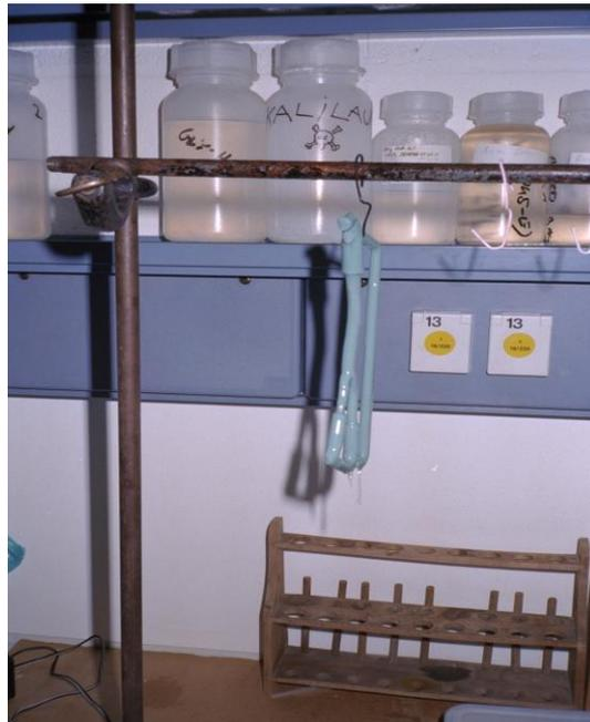
Bild 11: Antrocknen der Silikonschichten
