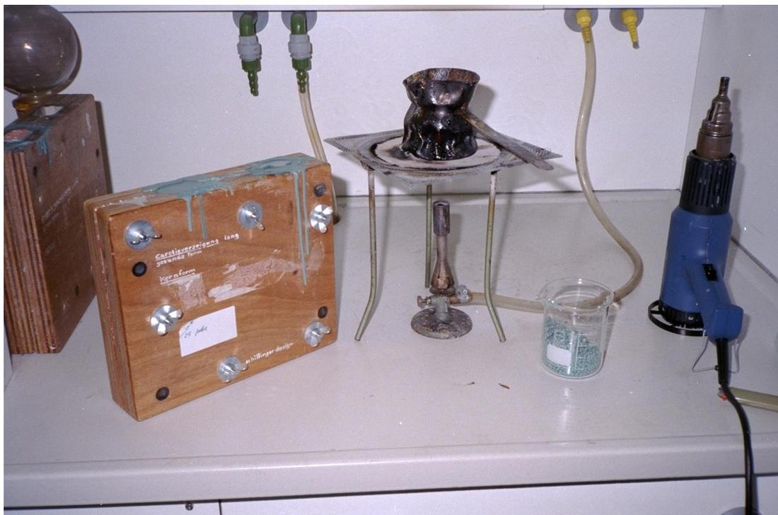
Bild 5: Schmelzen des Waxes über dem Bunsenbrenner. Links im Bild die Kernform
