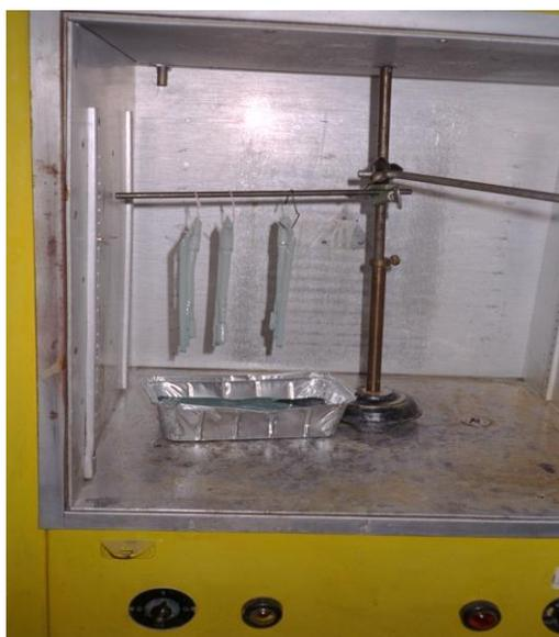
Bild 12: Schmelzofen: Der Wachs kern wird aus den Siliconmodellen herausgeschmolzen
