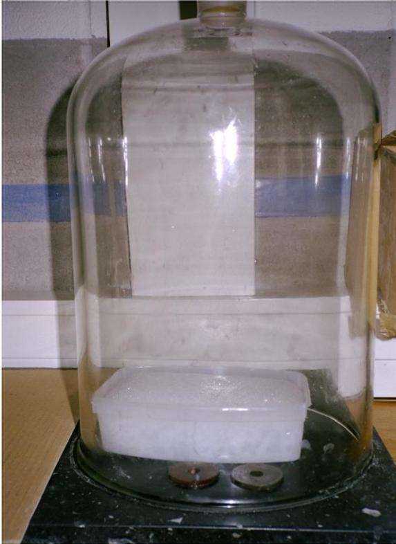
Bild 9: Evakuieren der Silikonmischung unter der Vakuumlöcke
