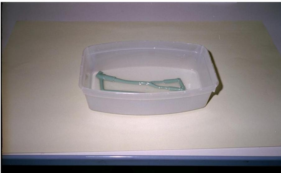
Bild 10: Eintauchen des Wackskerns in die Silikonmischung
