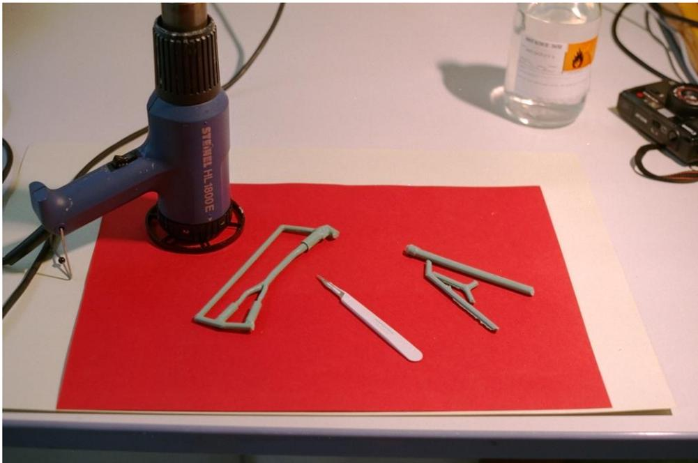
Bild 7: Entgraten des Wachs-kerns, Entfernen der überschüssigen Gußteile
