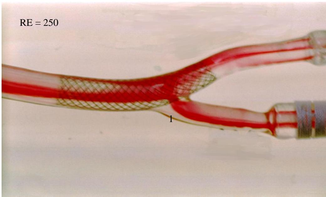
Bild 37: Modell Stent3, roter Farbfaden in der Mitte,  $Re=250$
