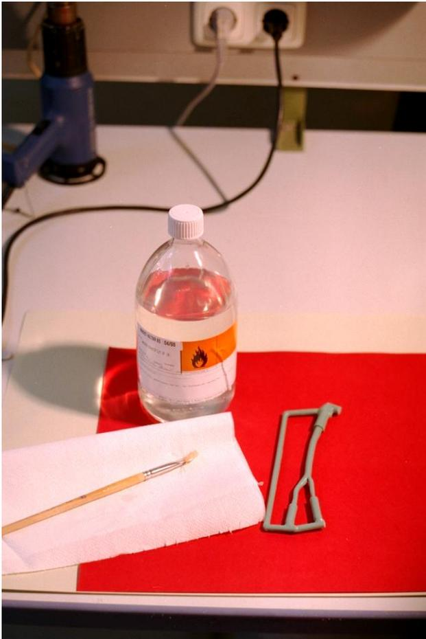
Bild 8: Bestreichen des Wachskerns mit dem Schutzfilm
