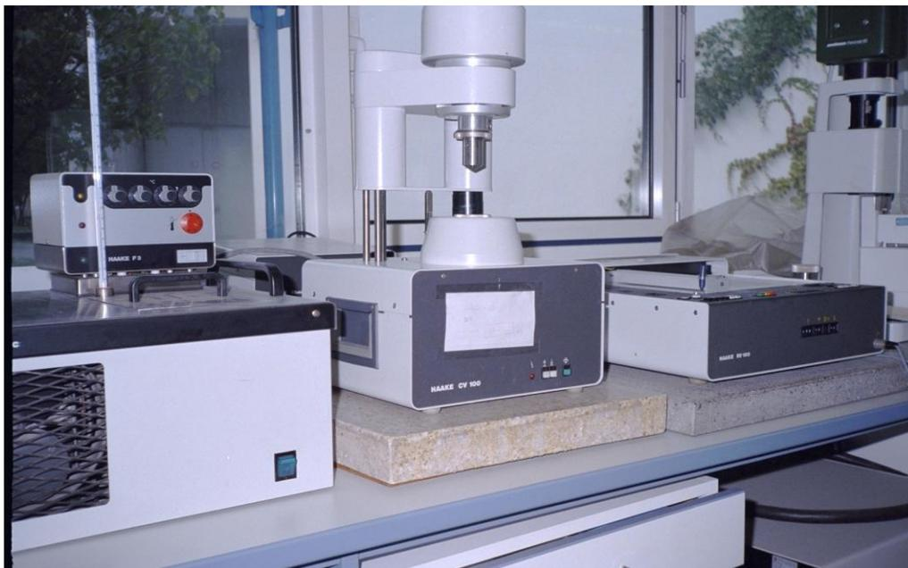
Bild 23: Viskosimeter mit Temperatureinheit und Schreiber
