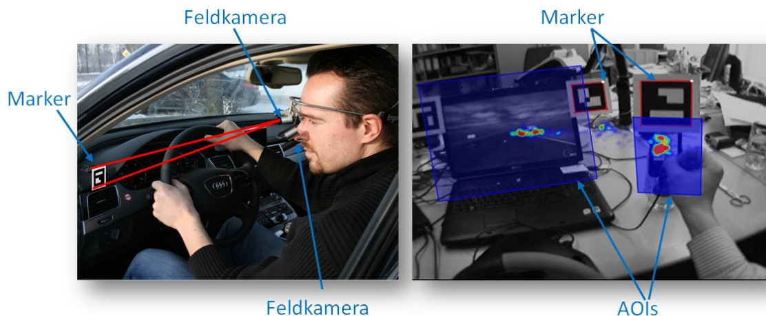
Abbildung 5-8: AOI-basierte automatische Auswertung von Kennwerten basierend auf Blickdauern in vordefinierte AOIs. Links: Aufnahme des Blickfilms mit der Head Unit von Dikablis; Rechts: Automatisierte Auswertung in D-Lab durch Einzeichnung von AOIs
