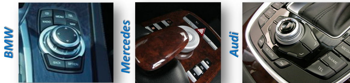
Abbildung 1-4: Abgesetzte Dreh- Drück- und Dreh- Drück- Schiebe- Steller zur Infotainmentbedienung von BMW, Mercedes und Audi
