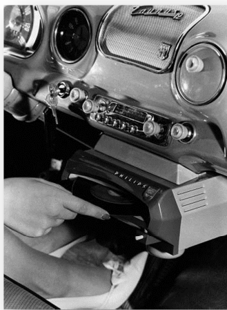
Abbildung 1-2: Nachrüstbarer Plattenspieler "Automignon" von Philips (Tunze, 2007)
