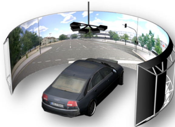
Abbildung 5-2: Statischer Fahr Simulator der Audi AG (Quelle: Audi AG)
