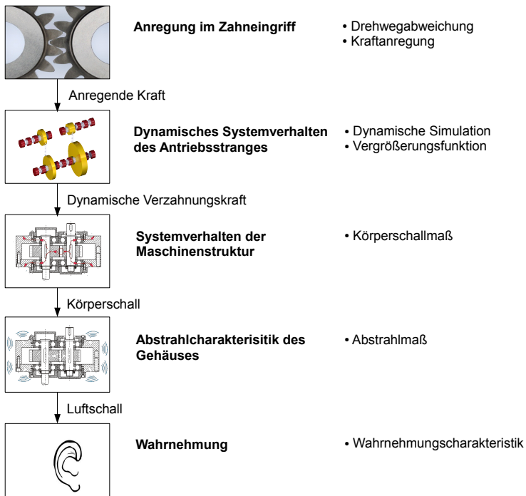
Bild 32: Schallübertragungskette für ein Zahnradgetriebe
