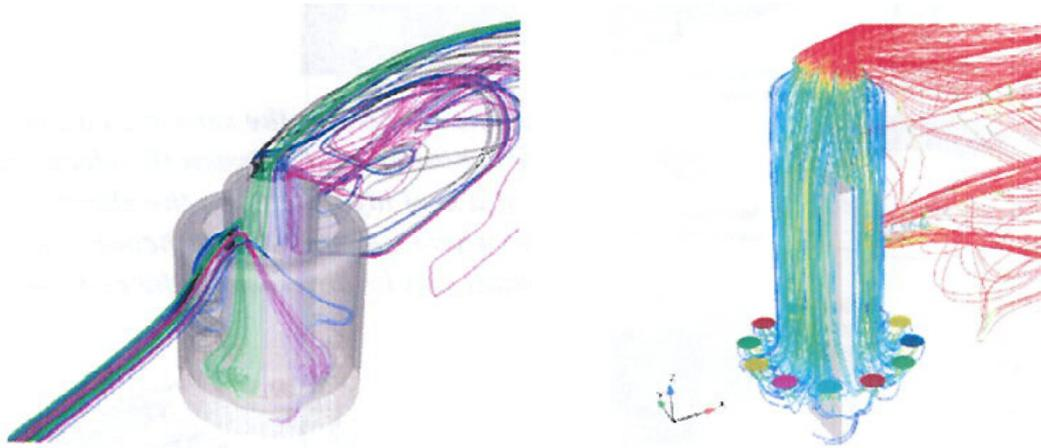
**Abbildung 3.10** Strömungssimulation der Gehäuse-Schutzkappe, links. Strömungsverlauf um das Sensorelement, rechts [40].
