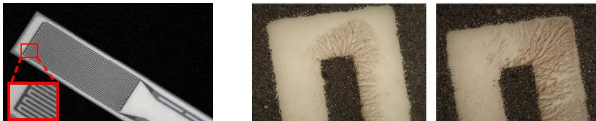
**Abbildung 2.23** Die auf dem Sensorelement angeordneten Interdigitalelektroden, links. Zwei Vergrößerungsbilder mit unterschiedlichen Rußbeladungen. Die Rußpartikel bilden Dendrite aus, die den Isolator (helle Fläche) zwischen den beiden Elektroden überbrücken, rechts [40, 196].
