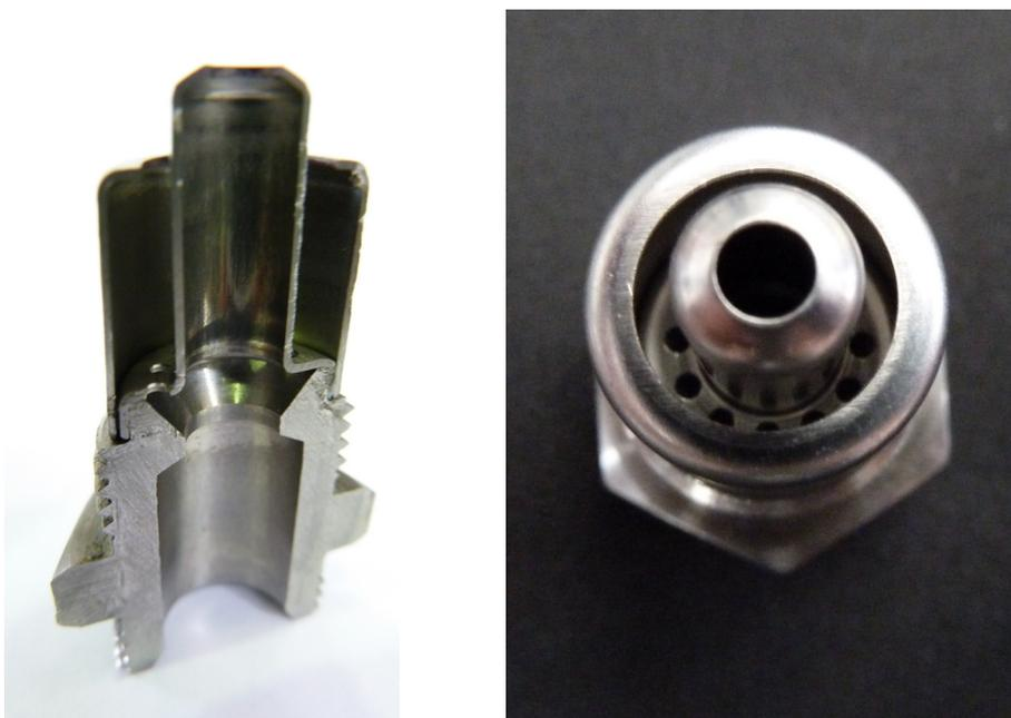
**Abbildung 3.9** Querschnitt durch die Sensorschutzkappe, links. Sensorschutzkappe mit Blick auf die radial verteilten Aerosol-Eintrittsbohrungen und die zentrale Austrittsbohrung, rechts.
