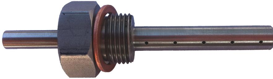
**Abbildung 3.14** Edelstahl-Lochsonde (Außendurchmesser 8 mm) für die Prüfgasdosierung mit 10 Bohrungen (Durchmesser 1 mm) senkrecht zur Strömungsrichtung des Abgases.
