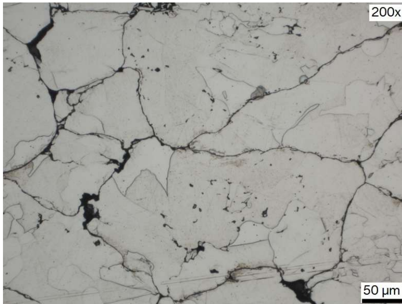
Abb. 6.17.: Lichtmikroskopische Aufnahme des Werkstoffes mit Partikelgrößen von 250-315μm in 200facher Vergrößerung. Schliff mit 3%iger Salpetersäure geätzt.
