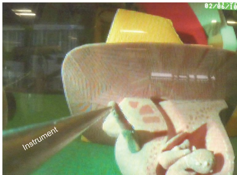
Abbildung 5-17: Momentaufnahme des Videos einer am Instrument befestigten Miniaturkamera, ausgerichtet an einem Ohrphantom. Das Instrument erscheint stets an der gleichen Stelle im Bild. Der Hintergrund bewegt sich, wenn sich das Instrument im Raum bewegt.
