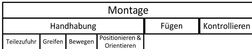
Abbildung 34: Montageprozess mit Basis- und Teilfunktionen
