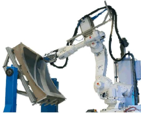
*Abbildung 26: Roboter mit Legekopf zur Faserablage (CORIOLIS COMPOSITES 2011)*
