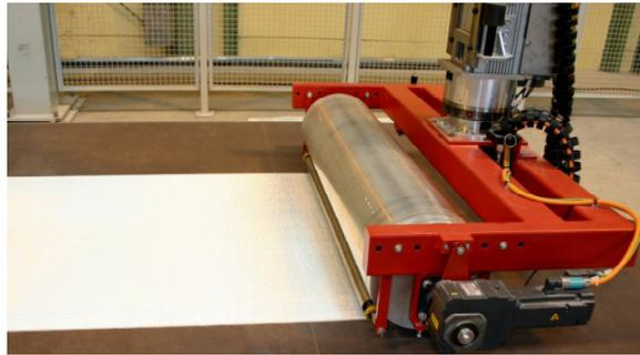
*Abbildung 9: PREBLADE-Endeffektor zur automatisierten Herstellung von Rotorblättern (WORTHMANN AUTOMATION GMBH 2011)*
