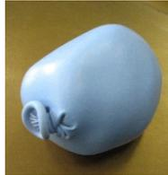
Die dehnbare, gummierte Außenhaut bewirkt, dass unter Druck eine Relativbewegung zwischen den Fasern entsteht, welche die Faserstruktur stark negativ beeinflusst --> Ausschluss dieses Prinzips.
