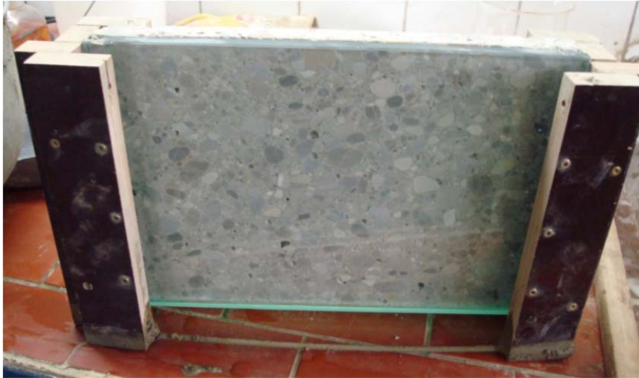
Abbildung 8.180: modifizierter Versuchsaufbau analog Abbildung 8.176 (eine Glasplatte wurde durch eine geschliffene Betonplatte getauscht)
