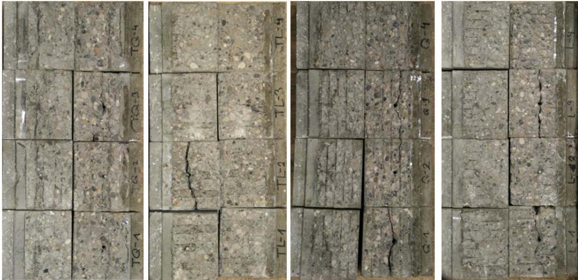
Abbildung 8.112: Bruchbilder (Keilspaltzugkörper am Fußpunkt aufgeklappt, Altbeton jeweils Rechts; Körper 1-3 bewehrt, Körper 4 unbewehrt) 1. v. L.: Trapezprofil quer (TQ) 2. v. L.: Trapezprofil längs (TL) 3. v. L.: Rechenprofil quer (Q) 4. v. L.: Rechenprofil quer (L)
