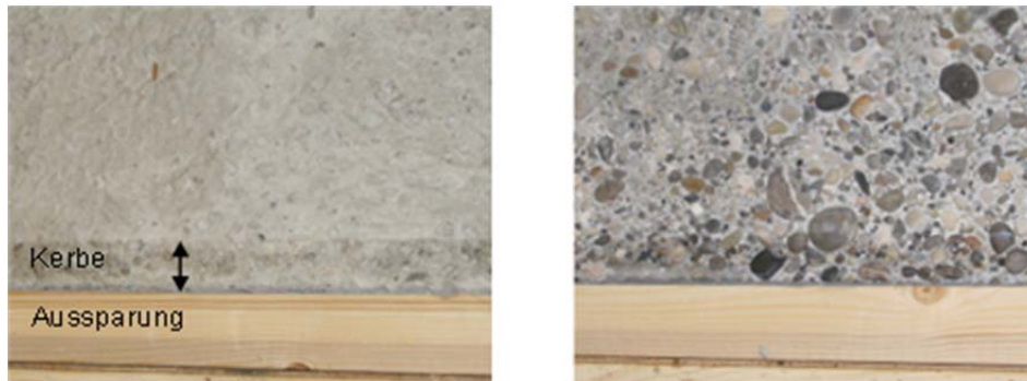
Abbildung 8.49: Variante 3, Kerbe mit Verbundbrecher ausgeführt Links: glatte, rüttelraue Oberfläche; scharfe Abgrenzung des Kerbrundes Rechts: raue, druckwassergestrayte Oberfläche; unregelmäßiger Kerbgrund
