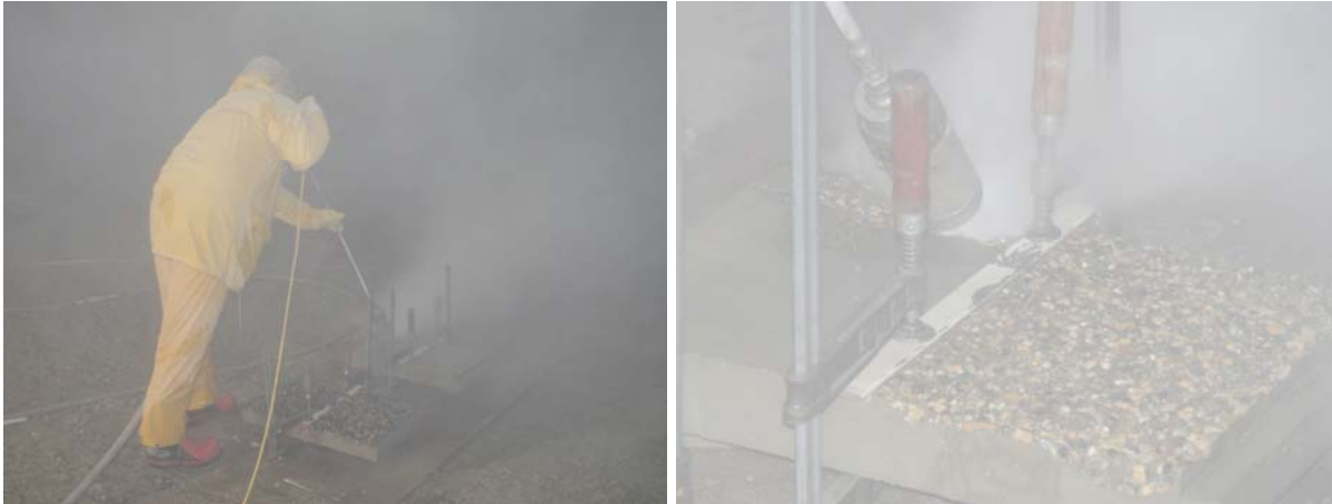
Abbildung 8.10: Druckwasserstrahlen der Probepplatten
