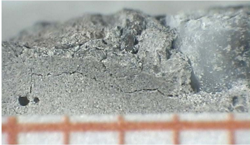
Abbildung 8.13: sandgestrahlte Oberfläche, parallel zur Oberfläche verlaufender Riss
