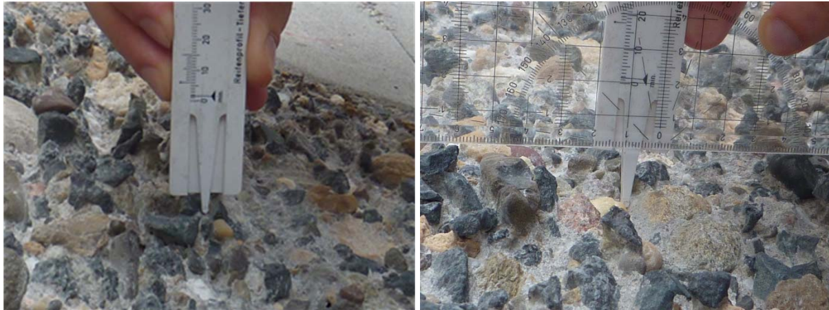
Abbildung 8.25: Rauheitsmessung mit Profilmesser Links: Basislänge ca. 20 mm Rechts: Basislänge ca. 110 mm
