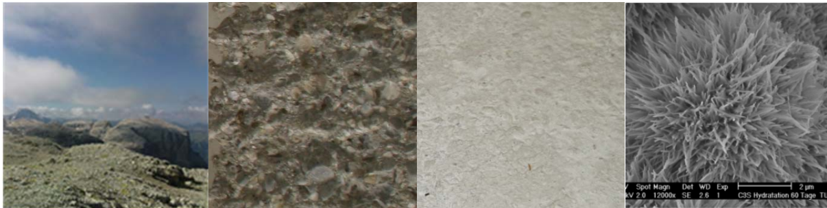
Abbildung 6.10: Oberflächen unterschiedlicher Rauheit (v. l. n. r. globale bis mikroskopische Rauheit)
