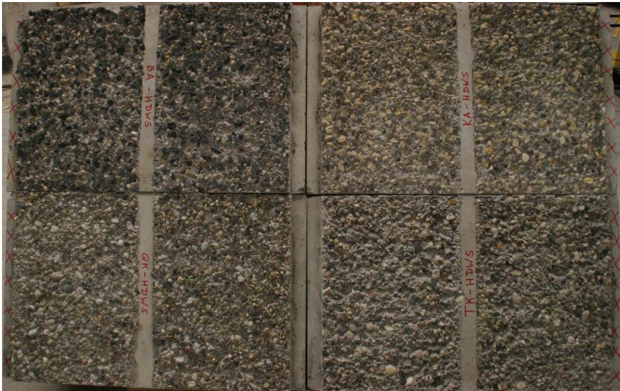
Abbildung 8.11: mit Druckwasserstrahlen aufgeraute Grundplatten (4 Stück) mit unterschiedlichem Grobzuschlag der Körnung 8/16
