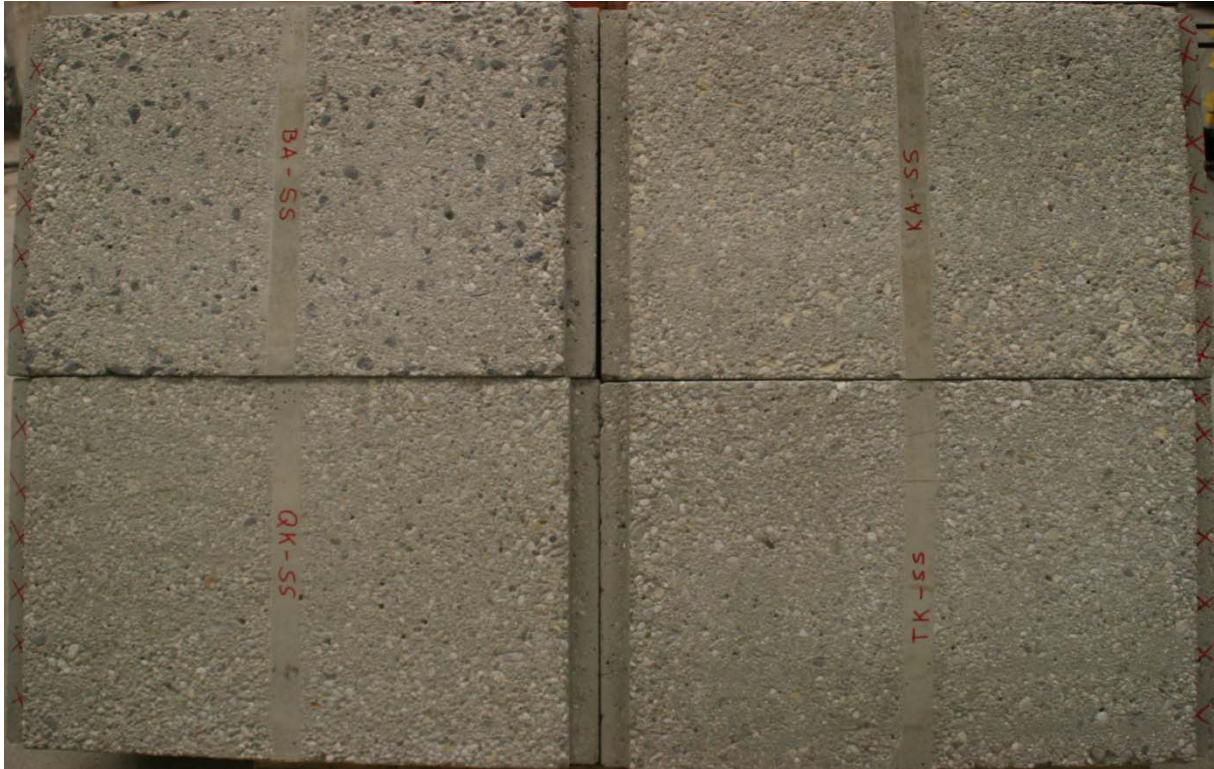
Abbildung 8.9: mit Sandstrahlen aufgeraute Grundplatten (4 Stück) mit unterschiedlichem Grobzuschlag der Körnung 8/16 Links oben: BA (gebrochenes Korn, Basalt), Rechts oben: KA (gebrochenes Korn, Kalk) Links unten: QK (gerundetes Korn, hoher Quarzanteil), Rechts unten: TK (gerundetes Korn, Terrassenschotter - „Standardkies“)
