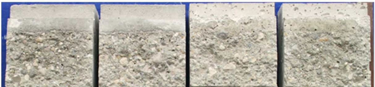
Abbildung 8.106: Bruchbild aufgeraute Oberfläche, 96 Stunden Betonierpause
