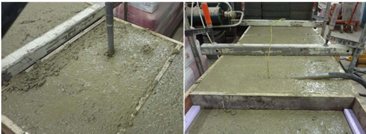
Abbildung 8.96: Links: Vertikales Eintauchen des Rüttlers, „vernadelt“ (RV) Rechts: Horizontales Eintauchen des Rüttlers in Neubeton (RH)
