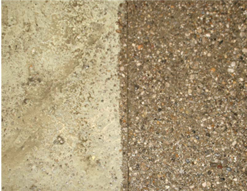
Abbildung 7.17: Druckwassergestrahlte Oberfläche Links: Oberfläche mit Verzögerer (vor dem Strahlen) Rechts: gestrahlte Oberfläche
