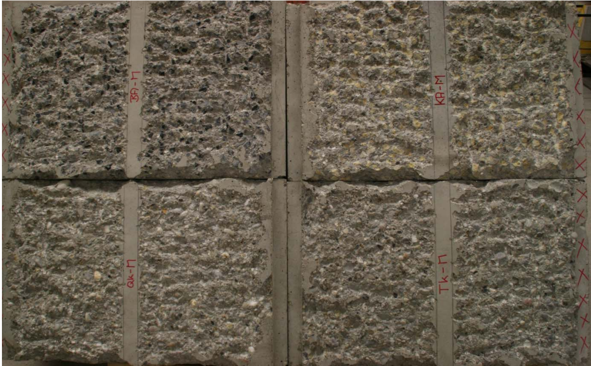
Abbildung 8.8: mit Stemmwerkzeug aufgeraute Grundplatten (4 Stück) mit unterschiedlichem Grobzuschlag der Körnung 8/16 Links oben: BA (gebrochenes Korn, Basalt), Rechts oben: KA (gebrochenes Korn, Kalk) Links unten: QK (gerundetes Korn, hoher Quarzanteil), Rechts unten: TK (gerundetes Korn, Terrassenschotter - „Standardkies“)
