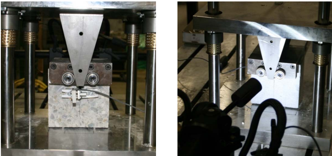
Abbildung 8.60: Versuchsaufbau Keilspaltzugversuch; Links: DD1-Wegaufnehmer zur Steuerung auf der Vorderseite Rechts: optische Verformungsmessung, gerissener Probekörper mit Specklemuster
