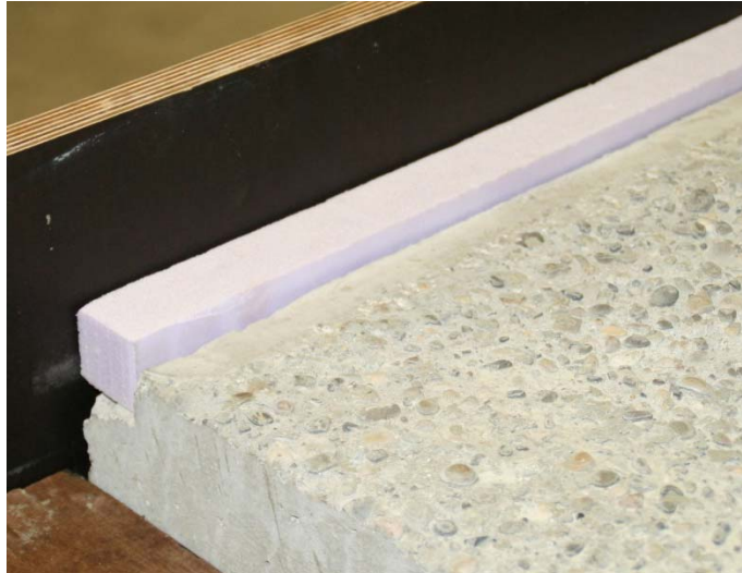
Abbildung 8.50: Kerbvariante, Kerbe mit PVC-Folie vorgegeben, Aussparung geschalt
