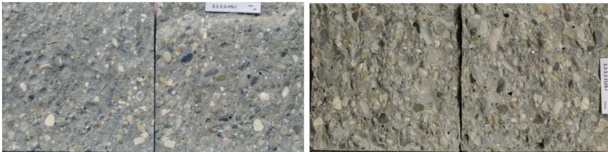
Abbildung 8.73: Links: Bruchbild des Verbundkörpers (links: Neubeton, rechts: Altbeton) Rechts: Bruchbild eines monolithischen Körpers
