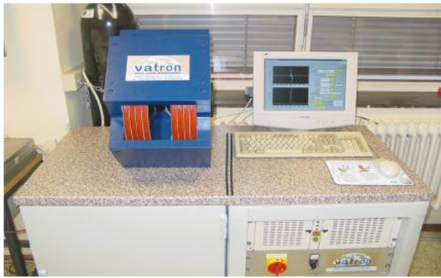
Abbildung 14: Gerät zur Bestimmung des Restaustenitanteils im Gefüge [55].
