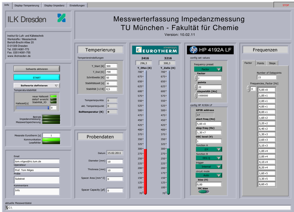
Abbildung 5.7: Startbildschirm des Programms IMP zur Eingabe der Messparameter bei einer Impedanzmessung am selbstgebauten Messplatz.
