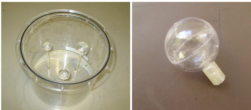
Abbildung 3.2: Phantom zur Kalibrierung des semiautomatischen Segmentierungsalgorithmus. Auf der linken Abbildung sind die 3 grössten, verwendeten Kugeln im Phantom fixiert. Der Durchmesser des Zylinders beträgt 20 cm. Rechts ist eine einzelne füllbare Kugel gezeigt.
