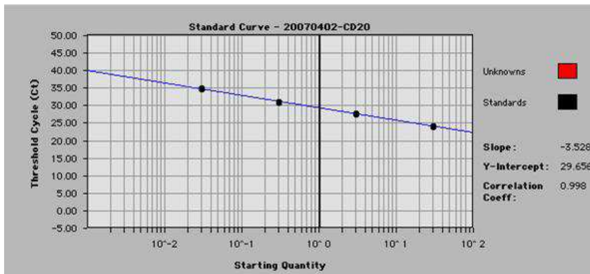
Abbildung 5: Standardkurve für CD20 in halblogarithmischer Auftragung. Abszisse: RNA-Menge in Nanogramm; Ordinate: gemessene Ct-Werte; Der Korrelationskoeffizient von 0,998 deutet auf einen hohen Grad des linearen Zusammenhangs hin.
