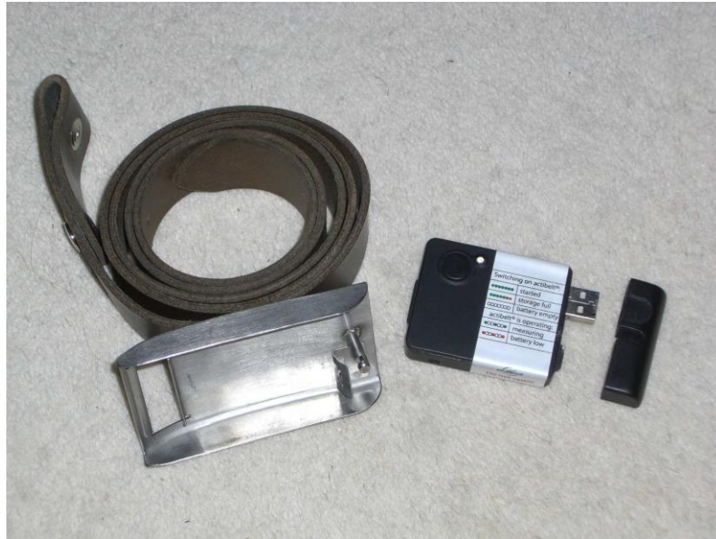
Abb. 2: actibelt®-Gürtel und Platinegehäuse mit Anschaltknopf, LED-Leuchte und USB-Anschluss
