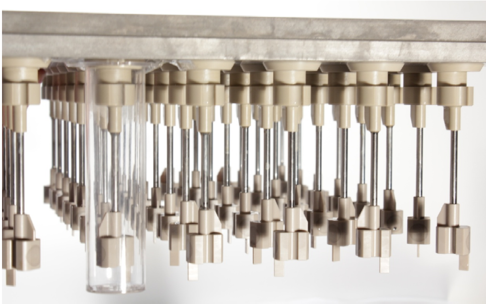
Abbildung 7.1: 48-fach gefertigte S-Rührer mit individuellem Milliliter-Rührreaktor ohne Strömungsbrecher im Vordergrund am Deckel des parallelen Rührkesselreaktorsystems.
