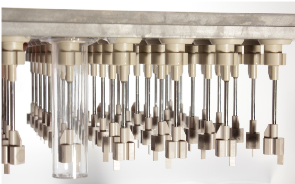
Abbildung 5.11: 48-fach gefertigte S-Rührer mit individuellem Milliliter-Rührreaktor ohne Strömungsbrecher im Vordergrund am Deckel des parallelen Rührkesselreaktorsystems.
