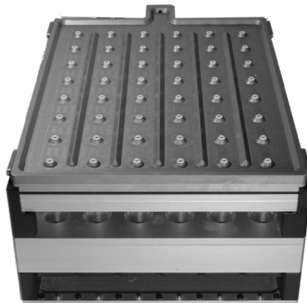
Abbildung 3.8: Rührkesselreaktorsystem bestehend aus 48 parallel betriebenen Rührreaktoren im Milliliter-Maßstab.
