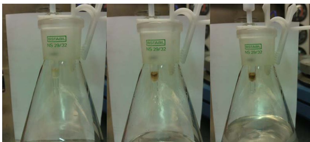
Abbildung 25: Monolithische Säule nach 5 min (links), 10 min (mittig) und 20 min (rechts) MAF.
