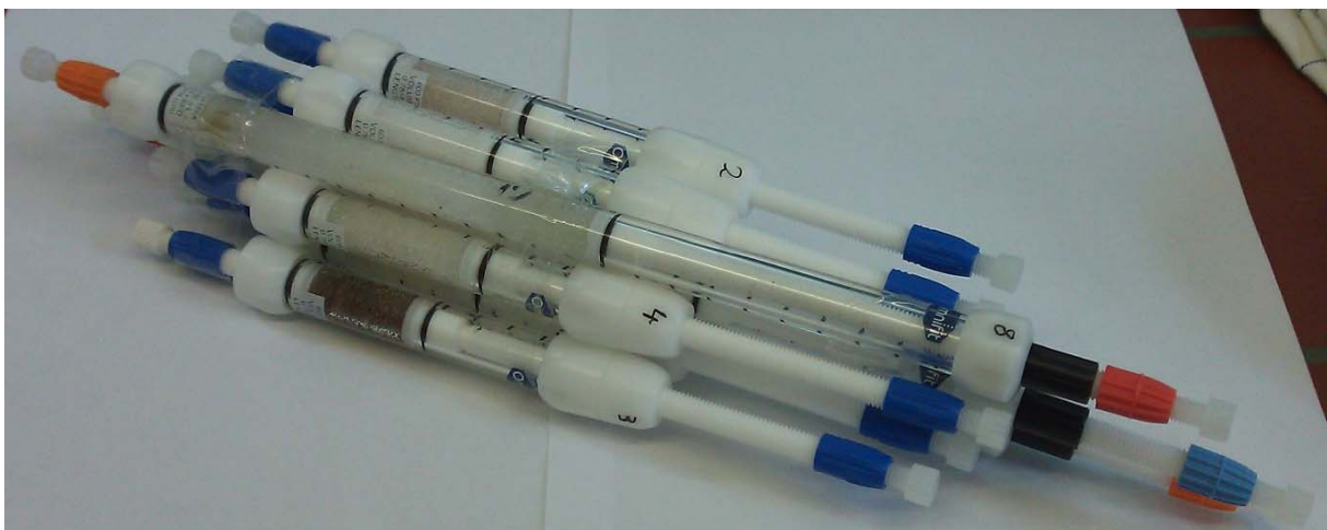
Abbildung 49: Foto der Packung aus 8 Säulen, die mittels MRT visualisiert wurden.
