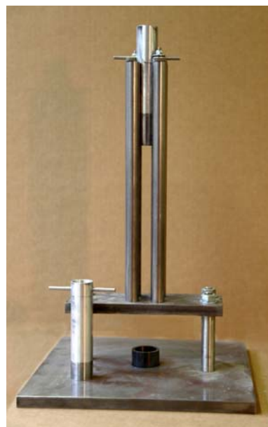
Abbildung 5-2: Einzelkornprüfgerät (links: schematische Prinzipskizze von K.-H. Kreft; rechts: praktische Umsetzung)
