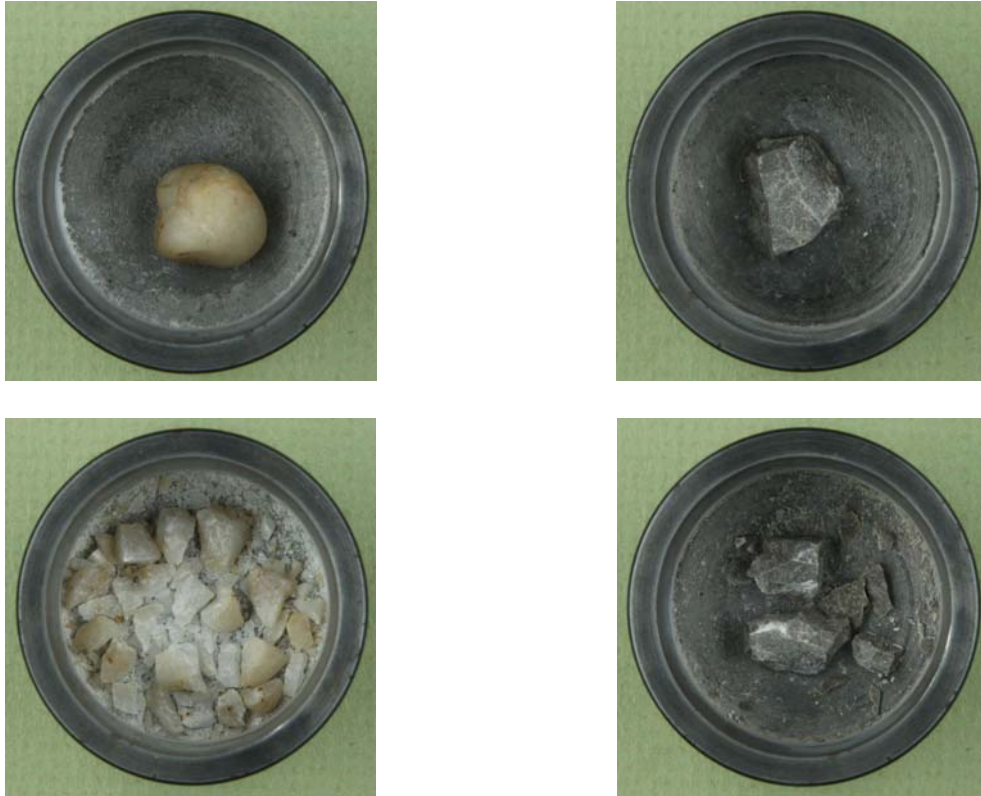
Abbildung 5-12: Typisches Bruchverhalten eines spröden Quarzes (links) und eines Kalksteins (rechts)
