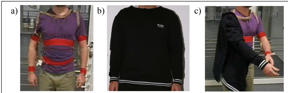
Abbildung 7-8: (a) Die fixierten Sensoren werden an den Armen und am Rumpf befestigt. (b) Zwei Messshirts der Größe L und XXL werden abwechselnd über fixierten Sensoren getragen. (c) Das Messshirt wird über den fixierten Sensoren getragen.
