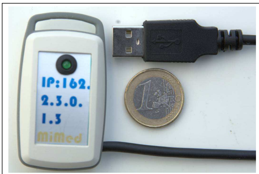
Abbildung 6-12: Das Empfangssystem wird über ein USB-Stecker am Rechner angeschlossen. Das System kann sich kabellos mit anderen Modulen verbinden.- Als Dimensionsreferenz dient eine Euro Münze.
