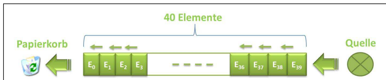
Abbildung 5-21: Schematische Darstellung eines Ringpuffers mit 40 Variablen
