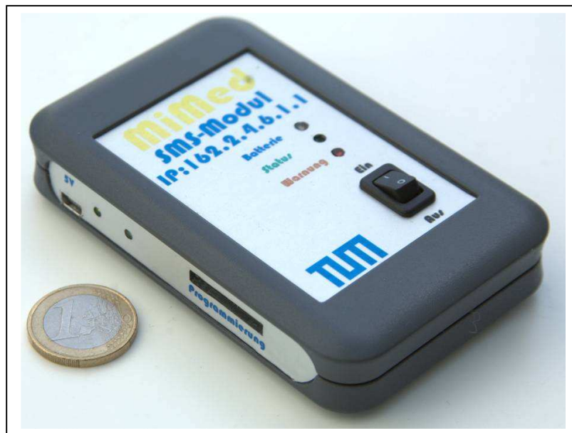
Abbildung 6-13: Das SMS-Modul zum Versenden gesundheitsrelevanter Informationen an festgelegte Personen- als Dimensionsreferenz dient eine Euro Münze.
