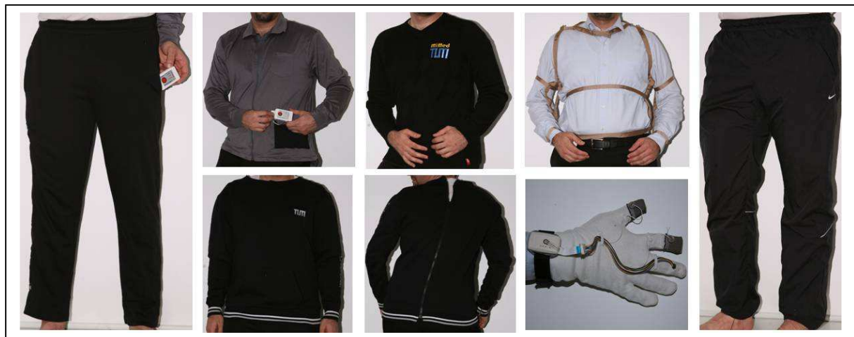
Abbildung 6-10: Die unterschiedlichen Shirts bzw. Hosenvarianten. Sie wurden für die Durchführung der Experimente in unterschiedlichen Größen aufgebaut. Jogginghosen, Shirts ohne und mit Reißverschluss vorne oder hinten sowie ein Shirt-Skelett mit fixierten Sensoren sind die unterschiedlichen Varianten, die hier entwickelt und aufgebaut wurden.
