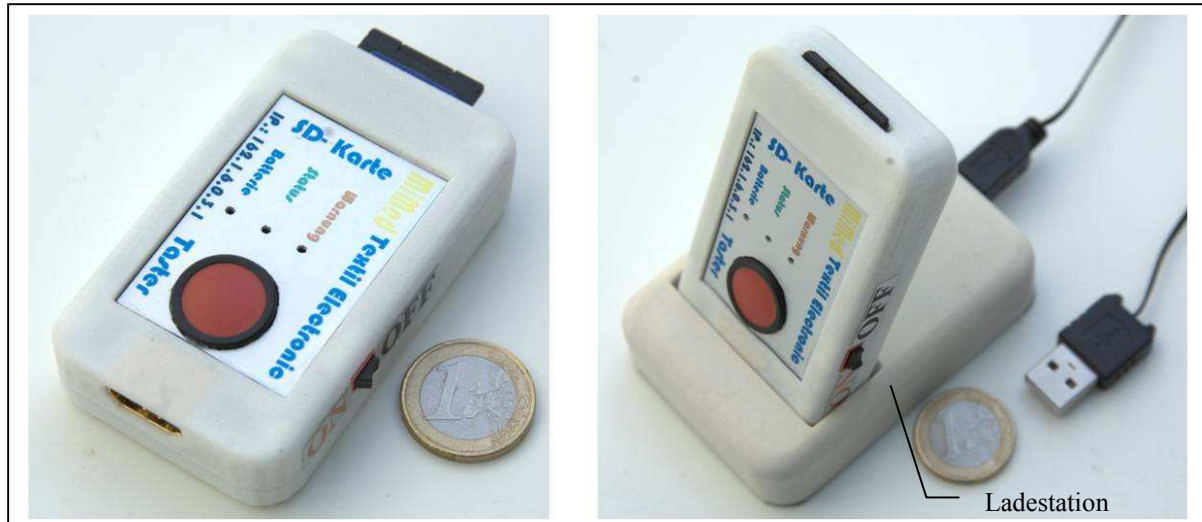
Abbildung 6-9: Das Elektronikmodul (links im Bild) kann über die Ladestation (rechts im Bild) aufgeladen werden- Zum Größenvergleich dient eine 1 Euro Münze.
