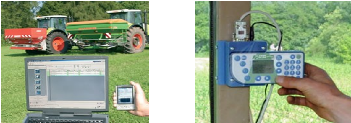
Abbildung 3: Hardware des Automatischen Schlagbezogenen Düngesystems (ADS) links (Quelle: Amazone) und Datenerfassungsgerät AutoDok von Landdata Eurosoft rechts (Quelle: Landdata Eurosoft)
