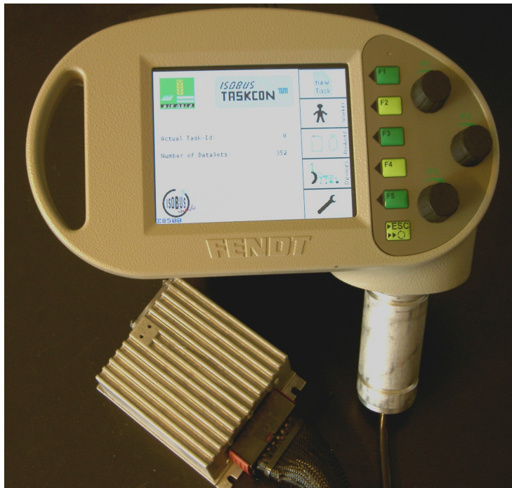
Abbildung 22: Prototyp eines ISOBUS-Task Controllers mit CPU und Bedienmaske auf einem Virtual Terminal
