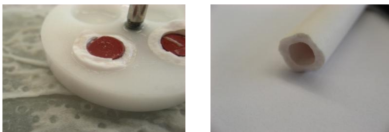
Abb. 6.5: Membranbruch (10 kDa Cutoff) nach einer Druckbeaufschlagung mit 200 MPa in drei Druckzyklen
