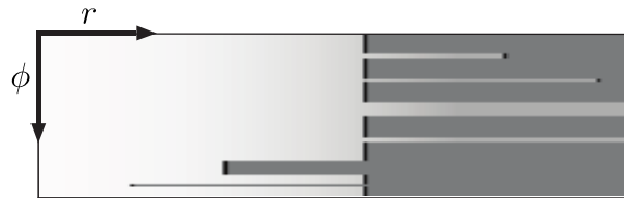
Abbildung 2.9: Mit simulierten Messwerten auf der GPU berechnete polare Belegungskarte mit 256 \times 70 Zellen.
