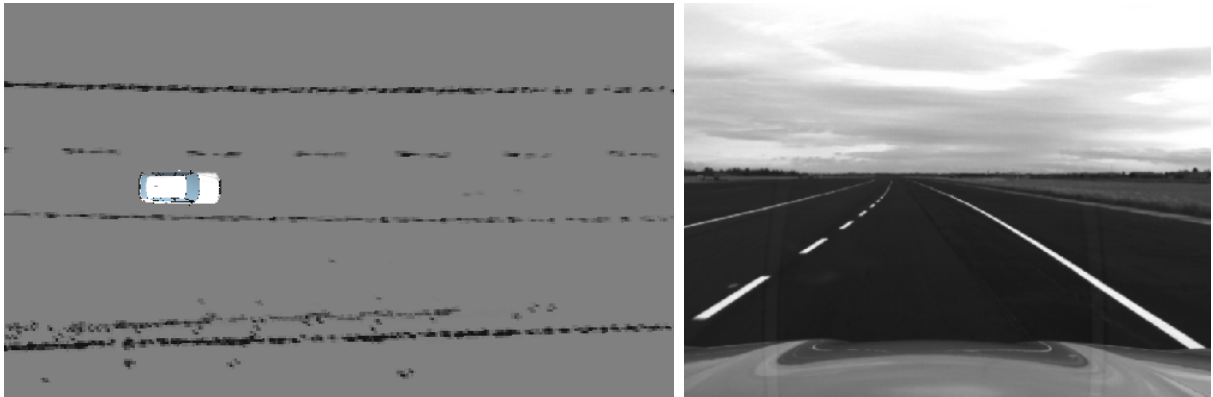
Abbildung 3.13: Erstes Beispiel für eine Belegungskarte mit Bodenpunkten. Idealer Fall aus Sicht einer anschließenden Parameterextraktion. Begünstigt durch einen sehr dunklen Fahrbahnbelag mit äußerst schlechter Oberflächenreflektivität \sigma_{br} , stammen alle bis zum aktuellen Zeitschritt t akkumulierten Bodenreflexionen von den eigentlichen Fahrbahnmarkierungen.
