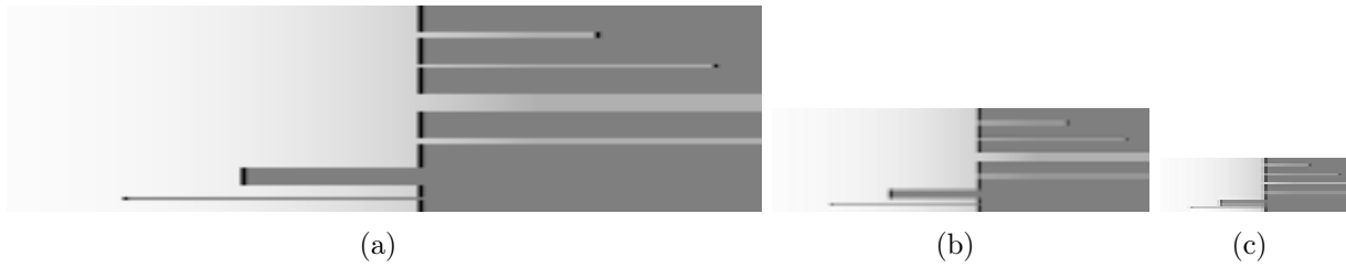
Abbildung 2.12: Beispiel für die Erstellung einer Mip-Map von Stufe d = 0 bis Stufe d = 2 . In (a), das Ausgangsbild mit voller Auflösung. In (b) in halbiertem und in (c) in geviertelter Auflösung.
