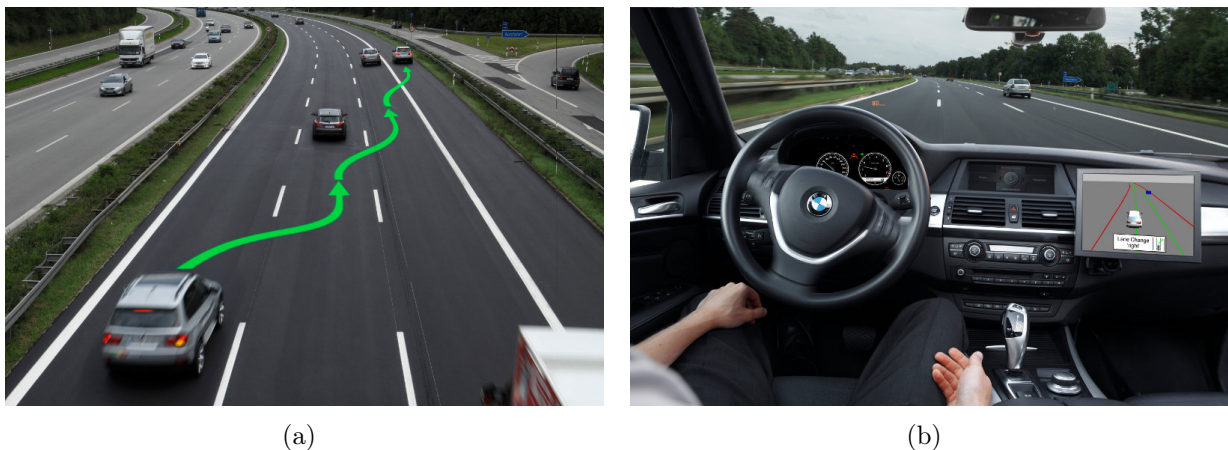
Abbildung 1.4: Beispiel für einen Nothalt auf dem Standstreifen auf einer Autobahn mit drei Fahrstreifen. Um in einen sicheren Fahrzustand zu gelangen, müssen unter Berücksichtigung des Verkehrs, drei automatisierte Fahrstreifenwechsel durchgeführt werden.
