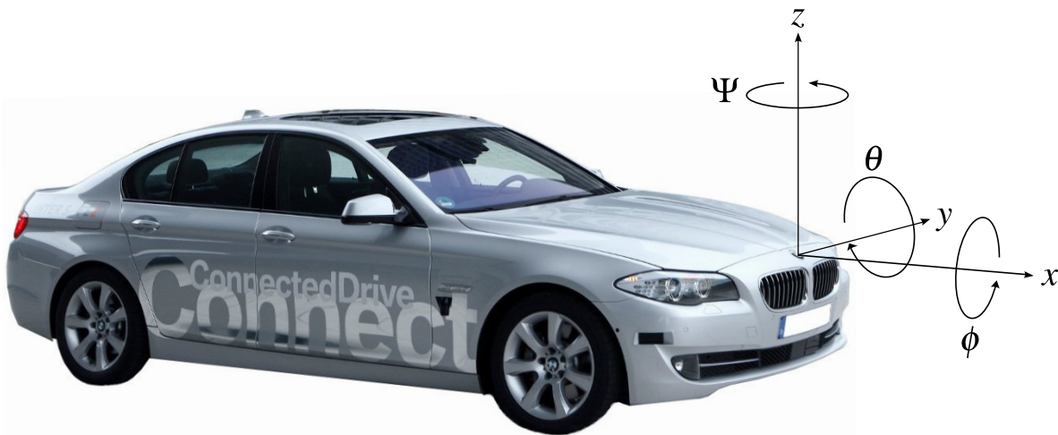
Abbildung 6.1: Verwendetes Fahrzeugkoordinatensystem mit den Sensorachsen x , y und z . Die Winkel \Psi , \phi und \theta beschreiben den Gier-, Roll- und Nickwinkel des Fahrzeugs.
