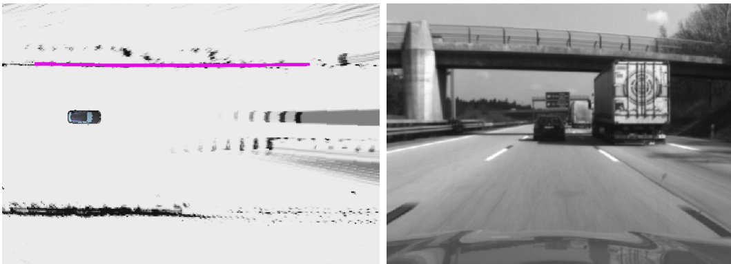
Abbildung 5.5: Beispiel für die Erkennung der linken Randbebauung. Die rechte Hypothese wurde aufgrund der großen lateralen Streuung der Messwerte wieder verworfen.
