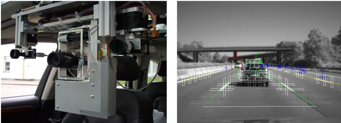
Bild 9: Kameraplattform ViSKA [33] (links) und Visualisierung der Fahrbahn- und Objekterkennung (rechts)
