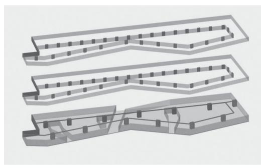
DIE NASSBEREICHE DER WOHNUNGEN SIND SO ANGEORNDNET, DASS SIE WEITGEHEND UEBEREINANDER LIEGEN. IM ERDGESCHOSS WERDEN DIE LEITUNGEN UNTER DER ABGEHAENGTEN DECKE GEBUNDELT. DURCH DIESE SCHAECHTE LAUFEN ALLE WEITEREN INSTALLATIONEN, WIE DIE REGENFALLROHRE, DIE SENKRECHT GEFUEHRT WERDEN MUESSEN.
