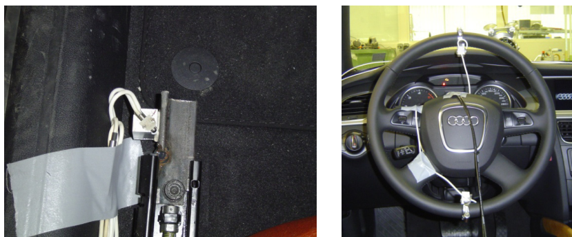
Bild 3.4: Beschleunigungssensoren an Sitzschiene und Lenkrad (Systemantwort)
