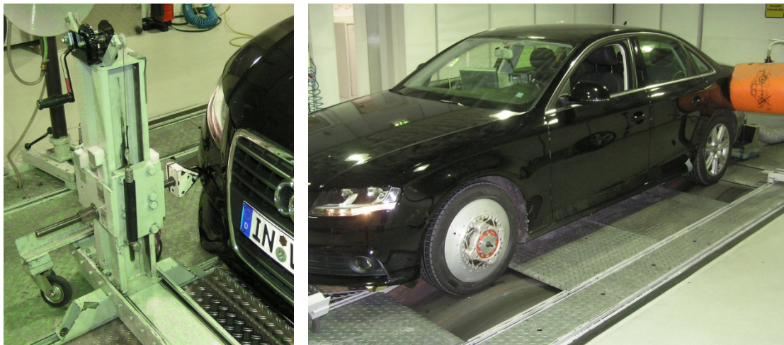
Bild 3.6: Befestigung des Versuchsfahrzeugs am Zweiachsrollenprüfstand
