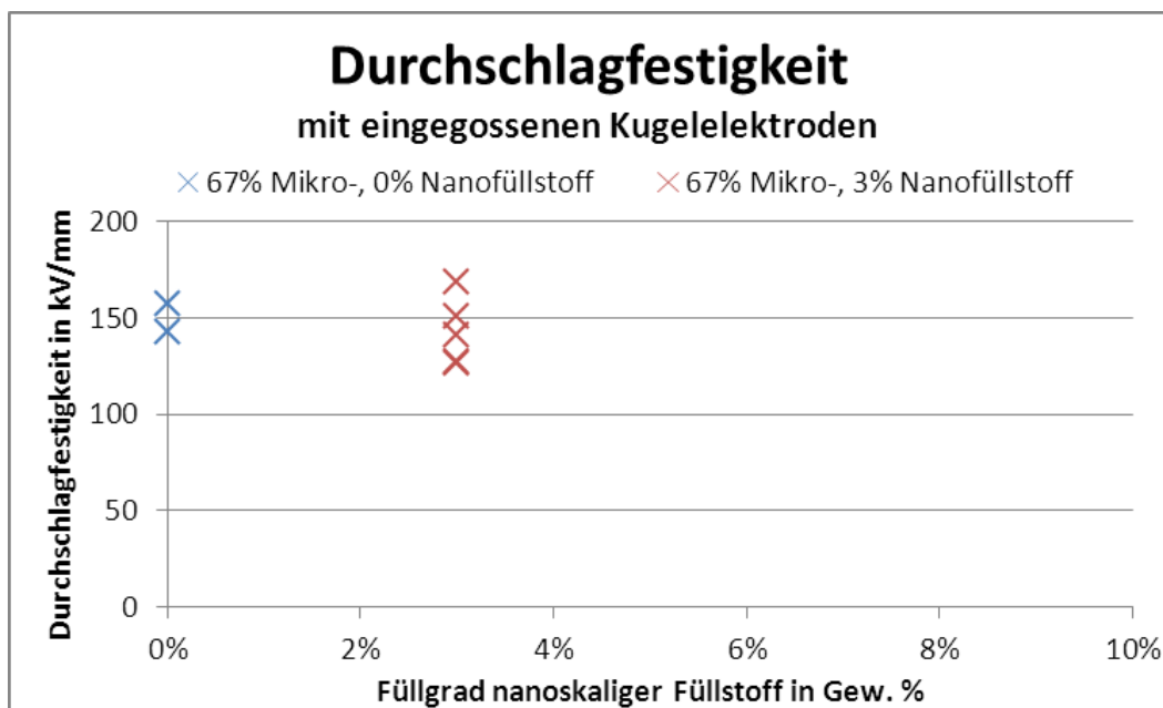
Bild 6-4: Durchschlagfestigkeit von Werkstoffen mit mikro- und nanoskaligem \text{Al}_2\text{O}_3 mit eingegossenen Kugelelektroden, Elektrodenabstand 0,8 mm.
