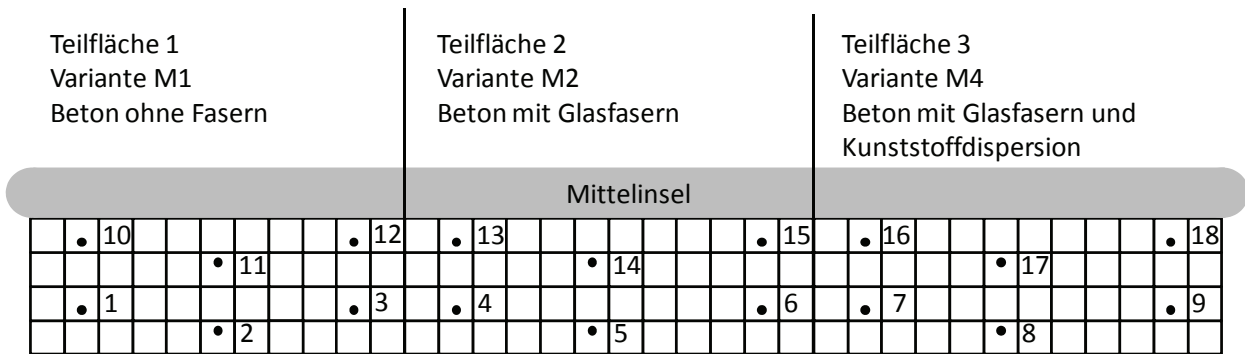
Bild 3.8: Entnahmestellen der Bohrkerne
