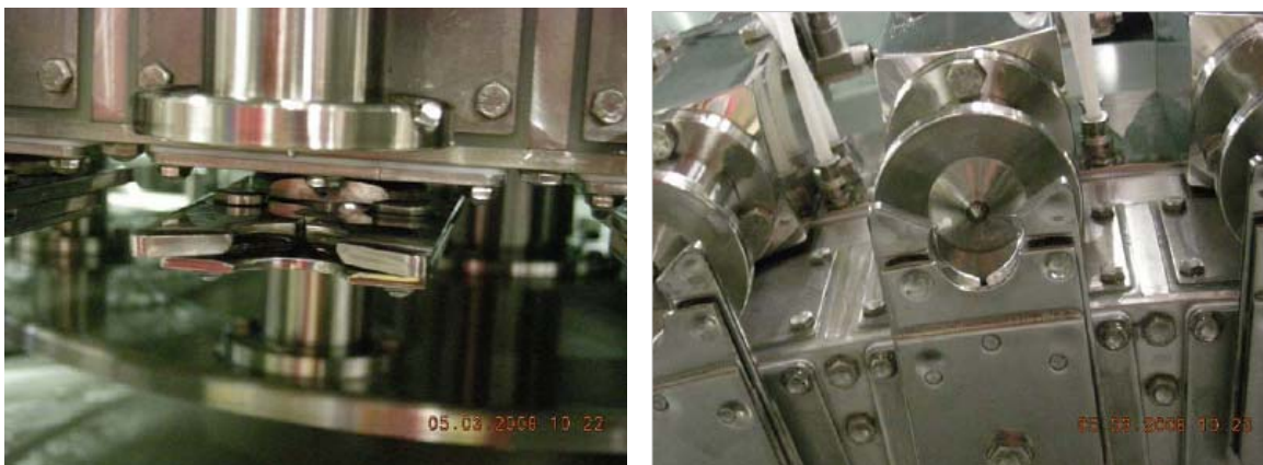
Abbildung 76: Mangelndes Hygienische Design im Bereich Füllventile
