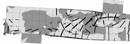
Bild 6.32: Verformter Dehnungszustand mit Rissen bei Maximallast der verschiedenen Simulationen
