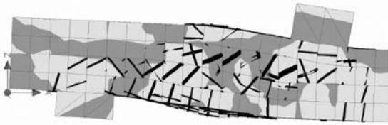
Mit in Schlitze verklebten CFK-Lamellen verstärkt und mit geripptem Betonstahl bewehrt
