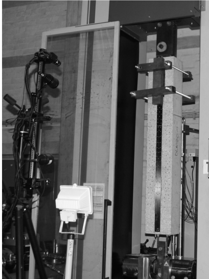
Bild 3.13: Abmessungen der Probekörper (Doppellaschenkörper) und der Versuchsaufbau für die idealisierten Endverankerungsversuche im Foto
