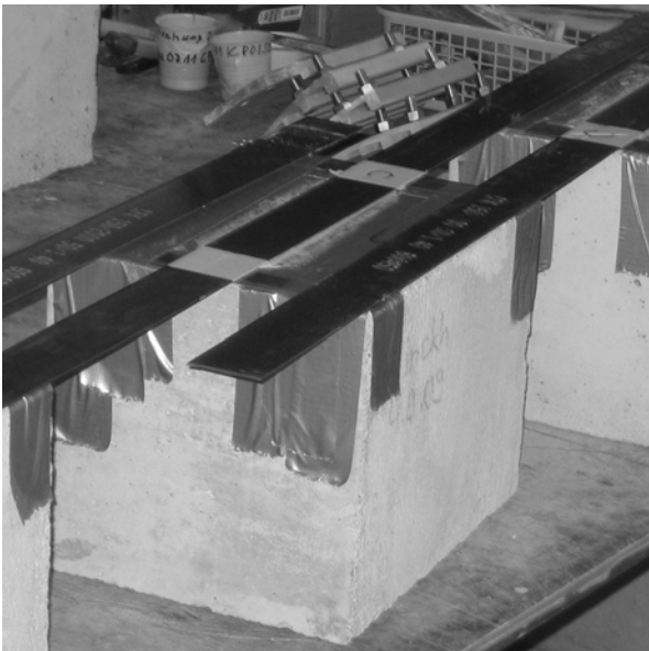
Bild 3.8: Einstellen der Klebstoffdicke durch Abstandshalter
