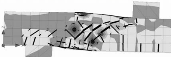
Bild 6.32: Verformter Dehnungszustand mit Rissen bei Maximallast der verschiedenen Simulationen
