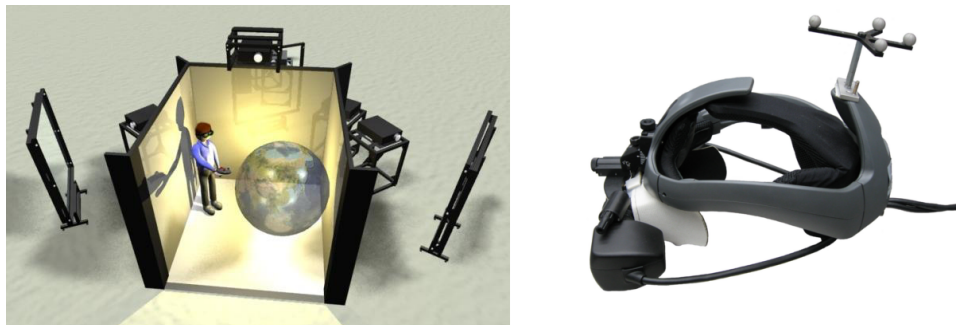
Abb. 2.13: Aufbau einer CAVE TM nach Araki u. a. (2007) (links), Head-Mounted Display ProView SR80-A von Rockwell Collins (rechts)
