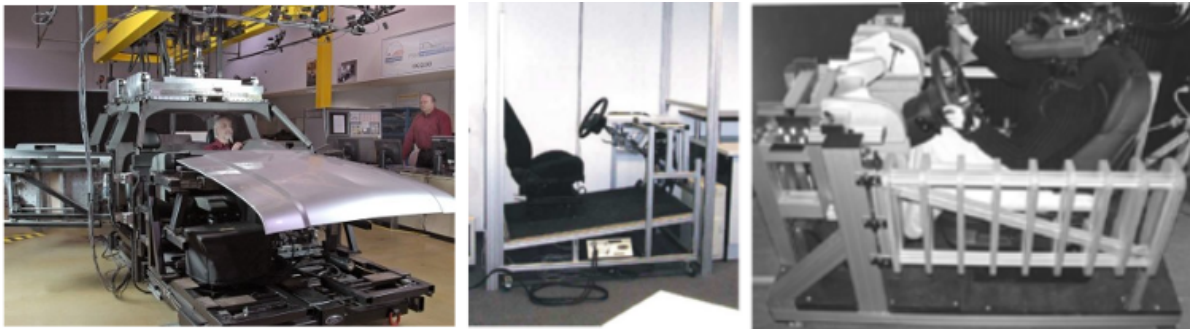
Abb. 2.4: Aufbauten physischer Sitzkisten. Links: variable Sitzkiste (nach Richards u. Bhise, 2004), Mitte und rechts: abstrahierte Sitzkistenaufbauten für VR-Anwendungen (nach Schrader, 2003; Voß, 2008)
