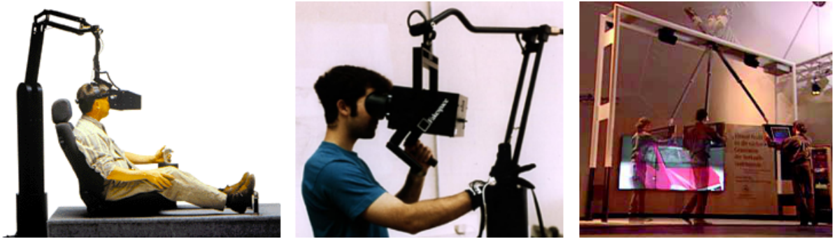
Abb. 2.15: Mechanische Positionierungssysteme. Links und Mitte: Binocular Omni-Orientation Monitor der Fa. Fakespace. Rechts: Virtual Car Display Aufbau von Art+Com (Vuylsteker, 2004; Waterworth, 1999)
