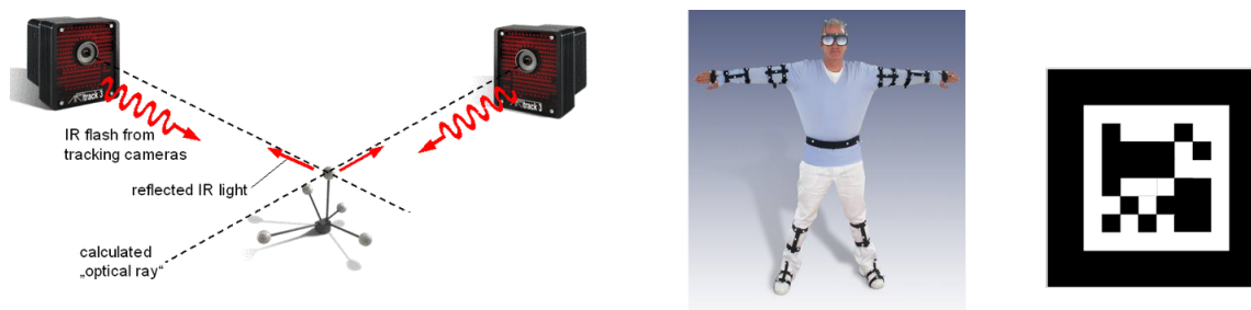
Abb. 2.16: Optische Positionierungssysteme. Links: Funktionsweise eines Infrarot-trackingssystems mit passiven Markern. Mitte: Passive Infrarottargets für Motion Capturing (beide Zürl u. Weiß, 2008b). Rechts: Marker für ein videobasiertes Trackingverfahren
