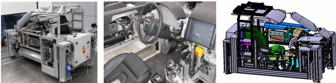
Abb. 2.18: Aufbau des virtuellen Fahrerplatzmodells: das Fahrerplatz-Mockup zur haptischen Rückmeldung
