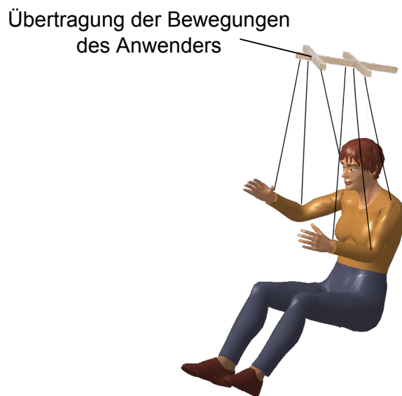
Abb. 4.5: Perzentilpuppe: Die Körperhaltung und Bewegungen des Anwenders werden in Echtzeit auf das virtuelle Körpermodell des Zielperzentils übertragen.
