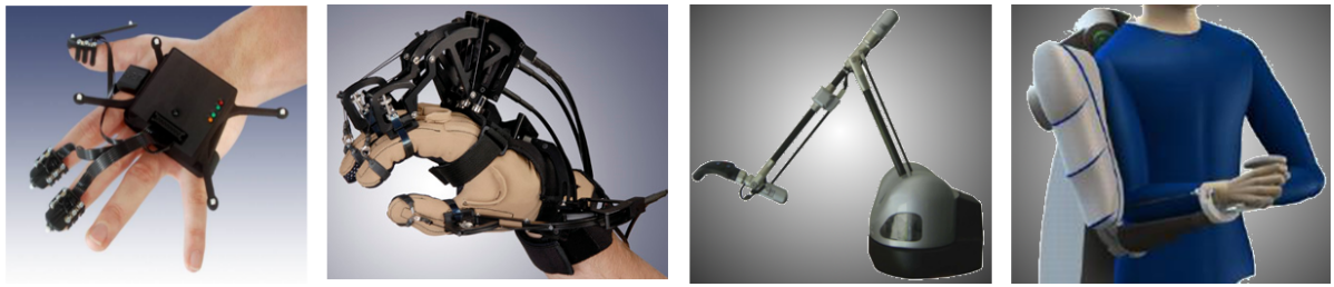
Abb. 2.14: Verschiedene haptische Displays. Von links nach rechts: taktiler Feedback an den Fingerkuppen mittels Druck und Vibration (nach Zürl u. Weiß, 2008a), Exoskelett zur Kraftrückkopplung für die Finger (nach Yazadi, 2010), Kraftrückkopplungssystem mit Handgriff (nach Haption, 2010), Exoskelett zur Kraftrückkopplung für Schulter, Ellbogen und Handgelenk (nach Roosen, 2010)
