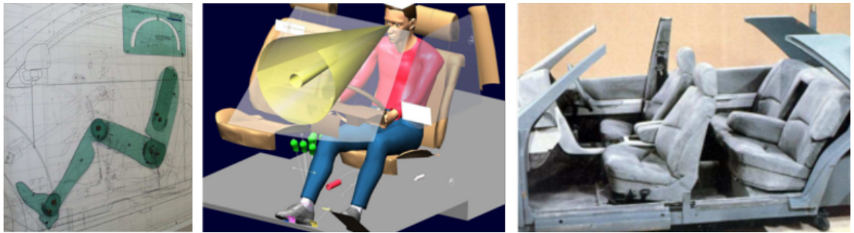
Abb. 2.3: Auslegungswerkzeuge für die Ergonomie im Fahrzeuginnenraum. Links: Bewegliche Ergonomieschablone (Schrader, 2003), Mitte: digitales Menschmodell Ramsis (Seidl, 2011) und rechts: 1:1-Modell des Fahrzeuginnenraums (Schrader, 2003)
