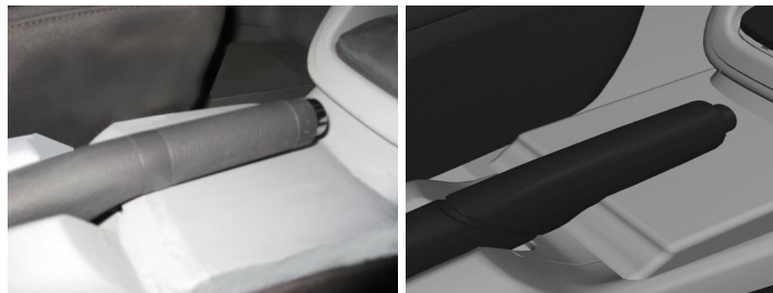
Abb. 3.11: Installierte Gestaltungsmängel an der Handbremse. Bedienbarkeit: Umfassen des Griffs nicht möglich. Reales Modell (links) und virtuelles Fahrerplatzmodell (rechts)
