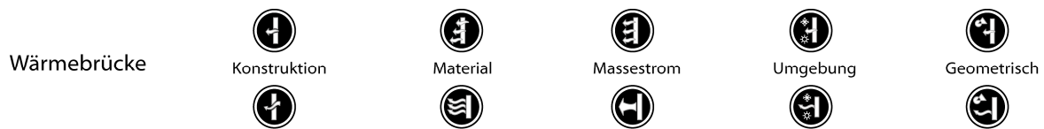
Abb. 89: Signaturen für die Wärmebrücken
