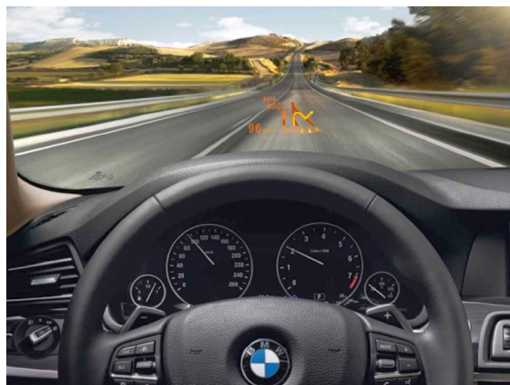
Abbildung 2.1: Das HUD erzeugt im Blickfeld des Fahrers ein virtuelles Bild, das circa 2 Meter vor dem Fahrer über der Motorhaube erscheint [Quelle: BMW].
