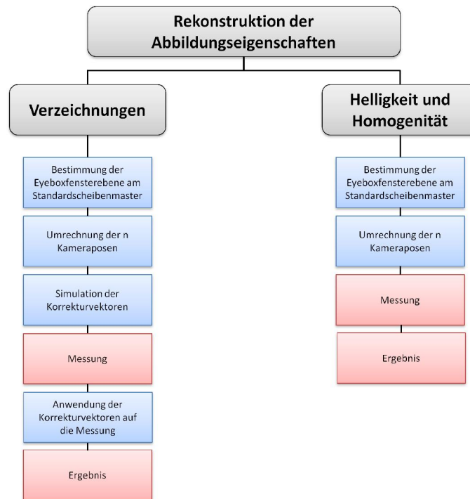
Abbildung 5.15: Arbeitsablauf zur Rekonstruktion der Abbildungseigenschaften für den spezifischen Scheibenmaster aus Messungen am Standardscheibenmaster.
