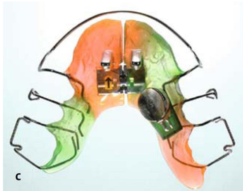
Abbildung 11: Theramon-System: Elektronik zum Compliancemonitoring bei Zahnspangen (Schott und Göz 2010a)
