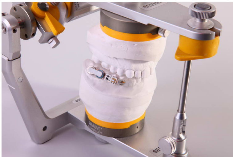
Abbildung 66: Fertiggestellte intelligente Zahnschiene im Artikulator (Foto: Sense Inside GmbH)
