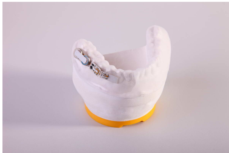
Abbildung 64: Schienenelektronik aufgeklebt auf der Tiefziehschiene (Foto: Sense Inside GmbH)
