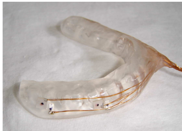
Abbildung 89: Testschiene mit nach Vorgabe eingebetteten Sensoren
