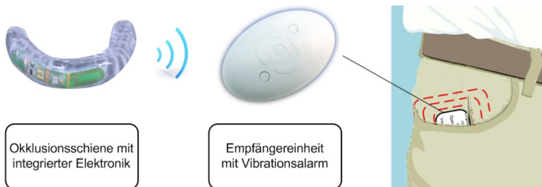
Abbildung 68: Therapie mit der Intelligenten Zahnschiene mittels Vibrationsfeedback im Empfänger (Probst 2005)
