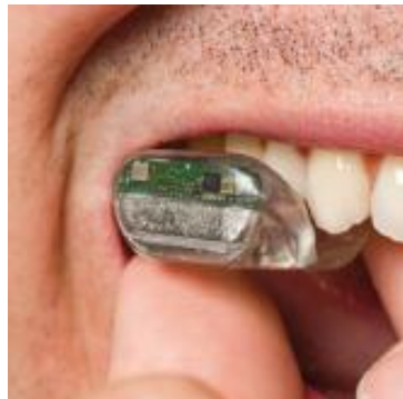
Abbildung 12: SoundBite System: Hörgerät auf Basis eines Vibrationsaktuators (Sonitus Medical Inc. 2011)
