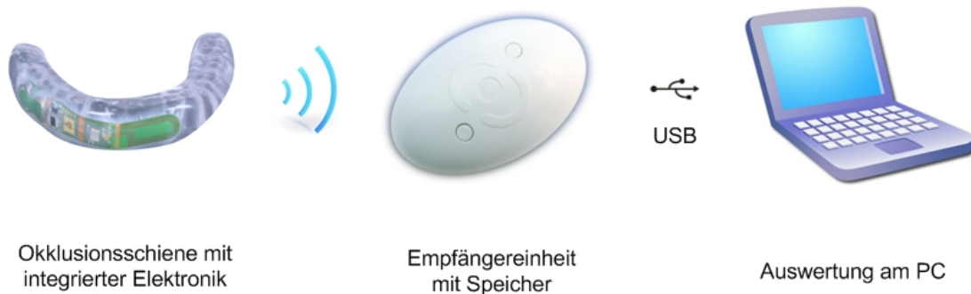
Abbildung 67: Diagnose mit der intelligenten Zahnschiene, einer Empfänger- und Speichereinheit, sowie einem Auswertecomputer
