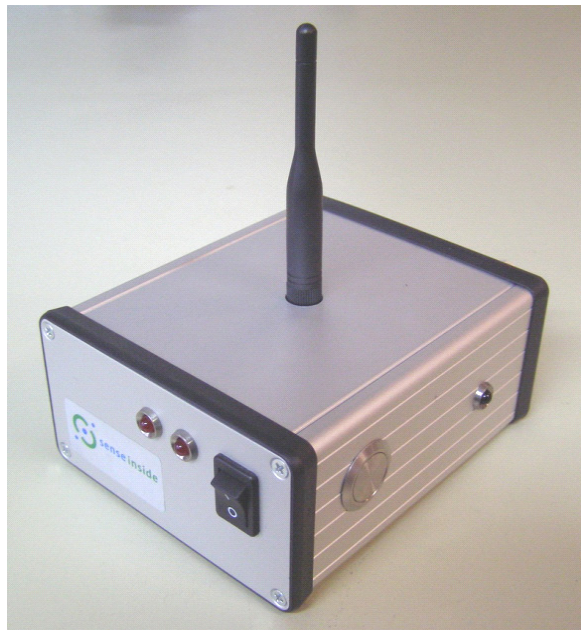
Abbildung 58: Empfänger für die Durchführung von Studien mit EMG mit der Möglichkeit der Ausgabe des Signals als Analogspannung
