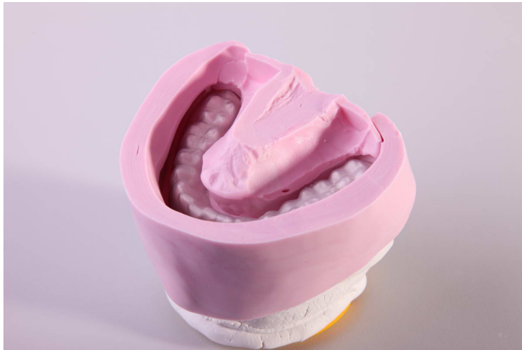
Abbildung 65: Manschette zum Gießen von flüssigen PMMA (Foto: Sense Inside GmbH)
