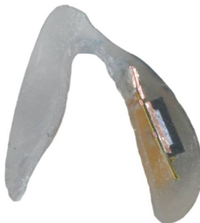
Abbildung 54: Schnitt durch eine Schiene mit Elektronik (Foto: Dr. Wolf-Dieter Seeher)
