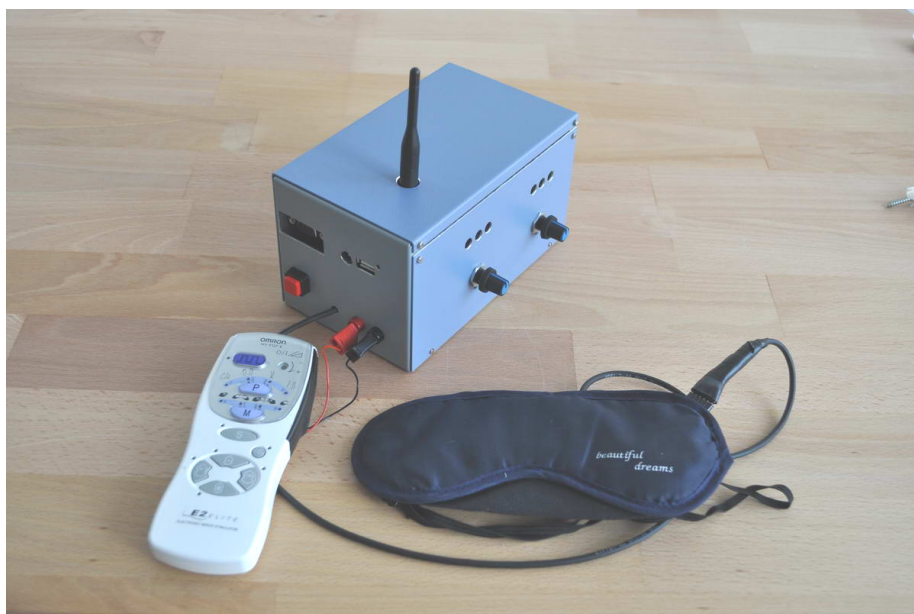
Abbildung 62 Biofeedbacksystem mit angeschlossenen Anwendungen Schlafbrille und Elektrostimulator (Röschke 2010, S. 70)
