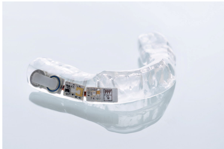
Abbildung 29: Zahnschiene mit integrierter intelligenter Schienenelektronik (Foto: Sense Inside GmbH)
